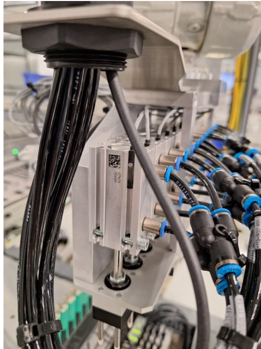
Slika 27. Prikaz hvataljke manipulacijskog robota
