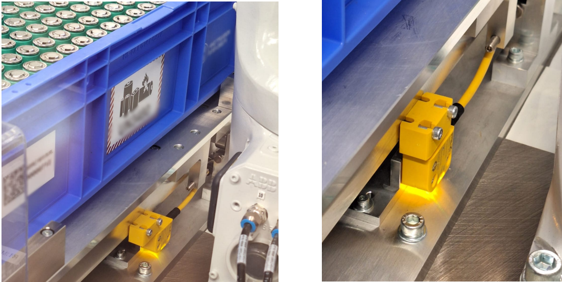
Slika 26. Detekcija pomoću magnetskih senzora
