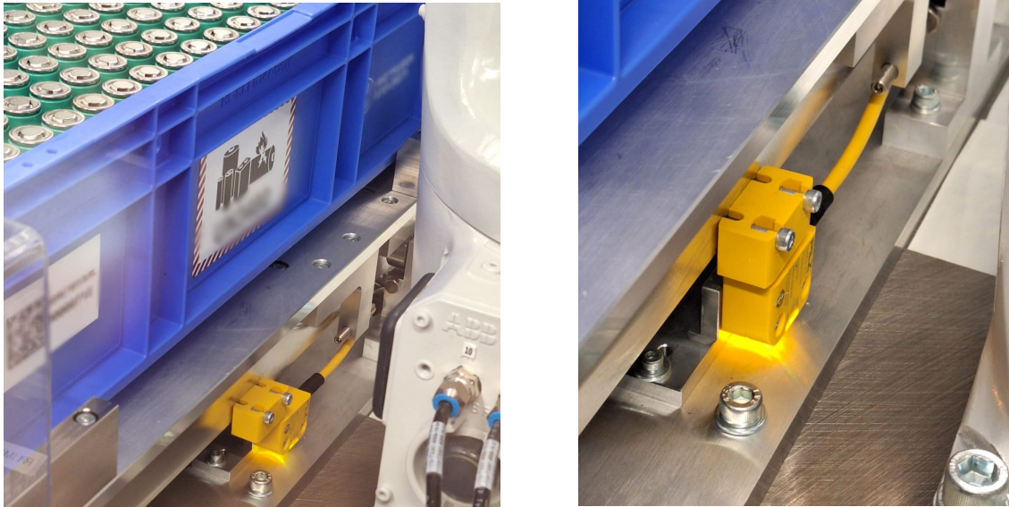
Slika 26. Detekcija pomoću magnetskih senzora
