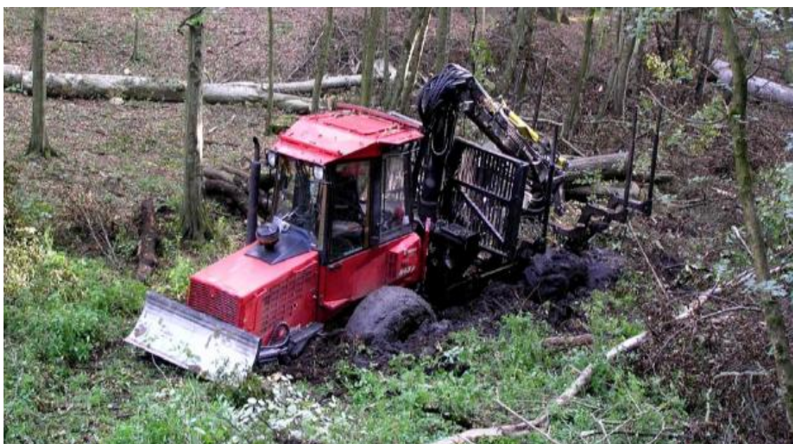
Slika 14. Forvarder zapeo na slabo nosivom tlu [6]
