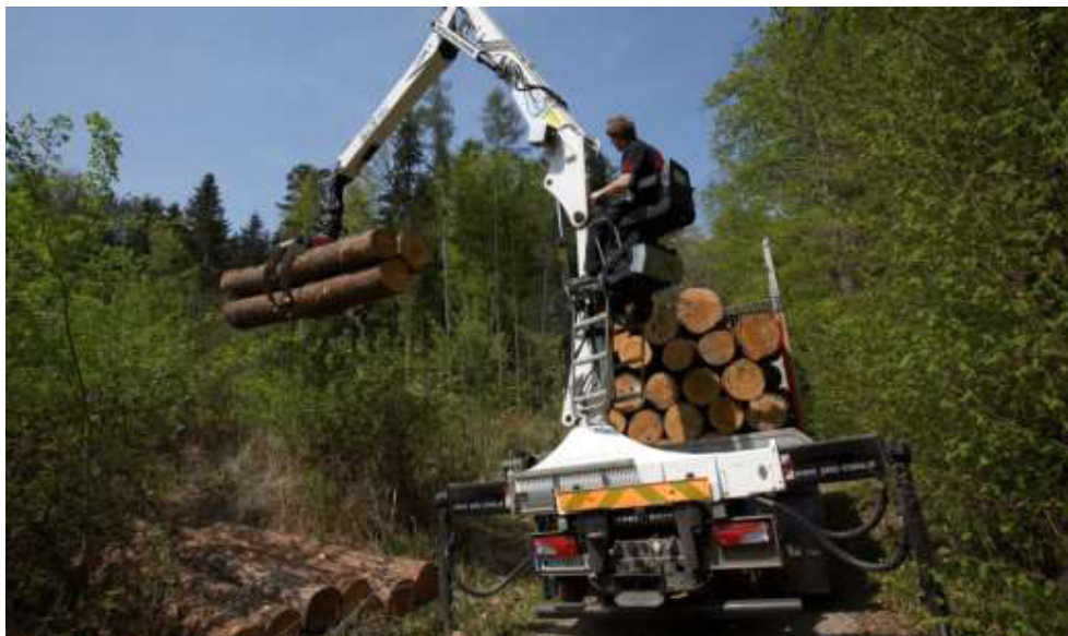
Slika 2. Prikaz radnika kod upravljanja šumskom dizalicom. [3]
