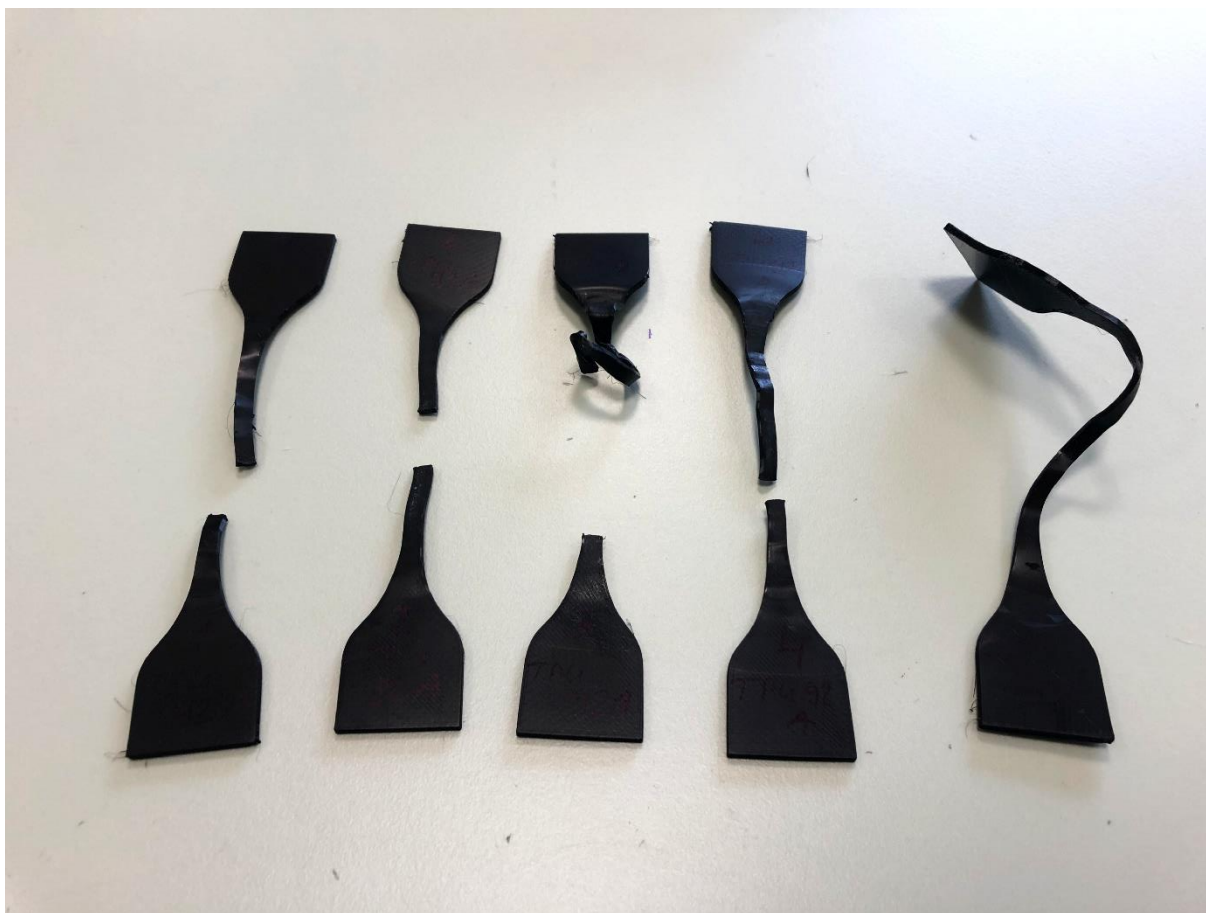
Slika 22. Epruvete Flexfill TPU 92A nakon ispitivanja na kidalici
