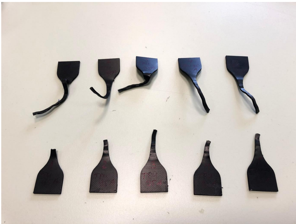
Slika 26. Epruvete Elegoo TPU 95A nakon ispitivanja na kidalici
