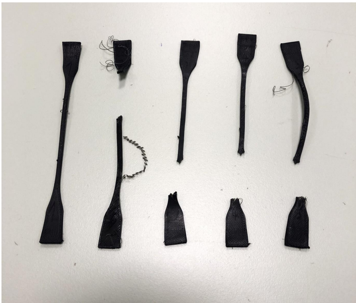
Slika 14. Epruvete Filaflex 60A „PRO“ nakon ispitivanja na kidalici
