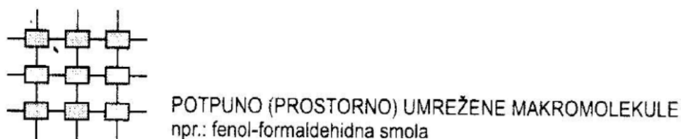
Slika 10. Oblik makromolekularne strukture duromera [1]
