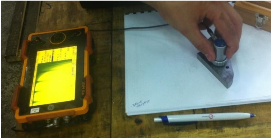
Slika 11.8. Baždarenje sonde na BD= 12.5 mm MP=50mm
