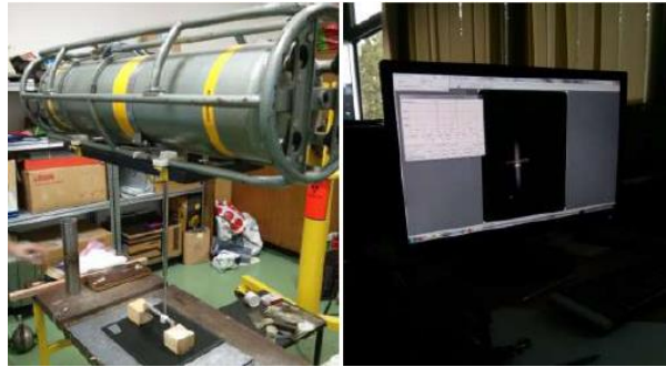
Slika 2.4. Uređaj za radiografiju (lijevo), obrada radiograma na računalu (desno) [4]
