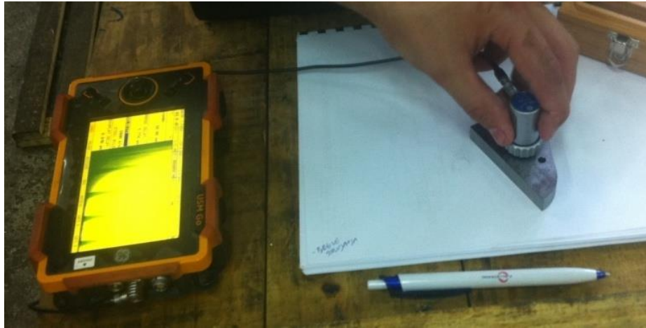
Slika 11.8. Baždarenje sonde na BD= 12.5 mm MP=50mm
