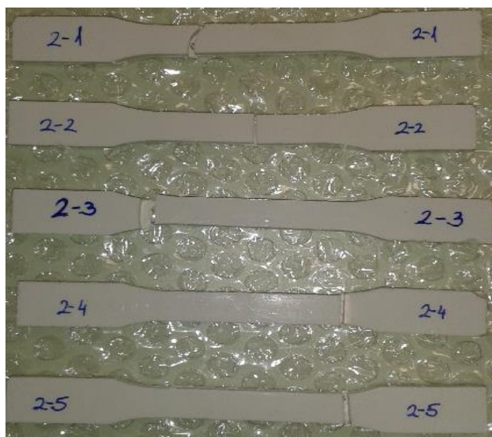
Slika 59. Akril ojačan staklenim vlaknom nakon ispitivanja
