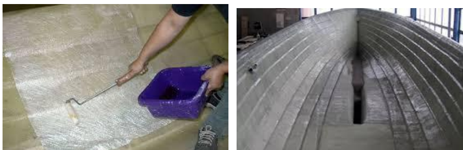
Slika 33 i 34. Izrada trupa broda od fibreglassa
