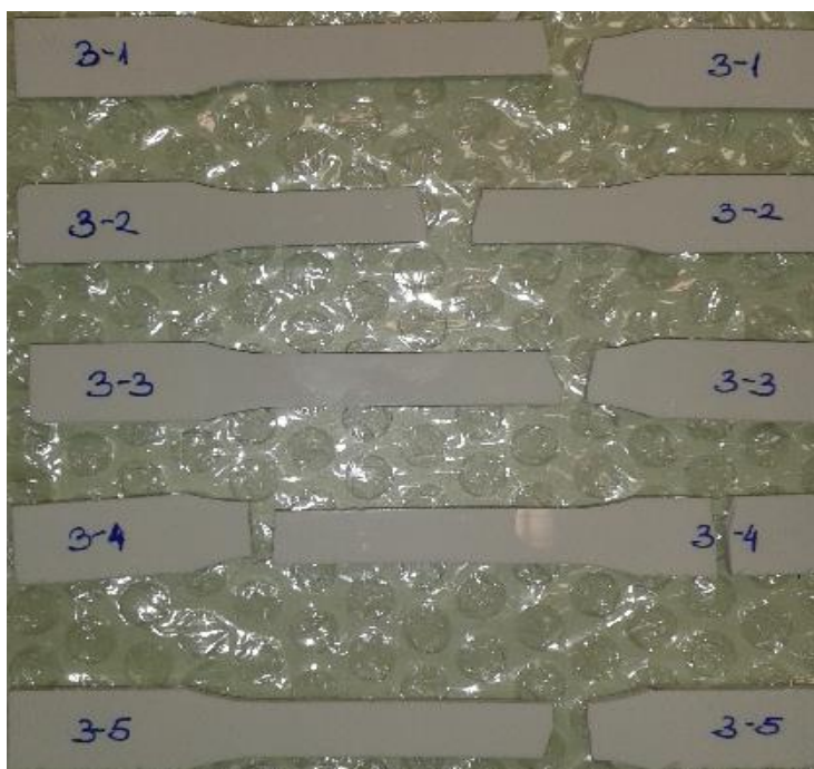
Slika 60. Akril nakon puknuća
