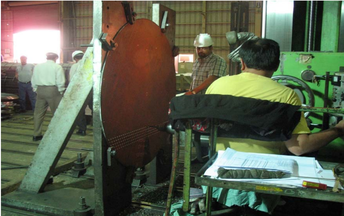
Slika 46. Postupak bušenja razdjelne ploče
