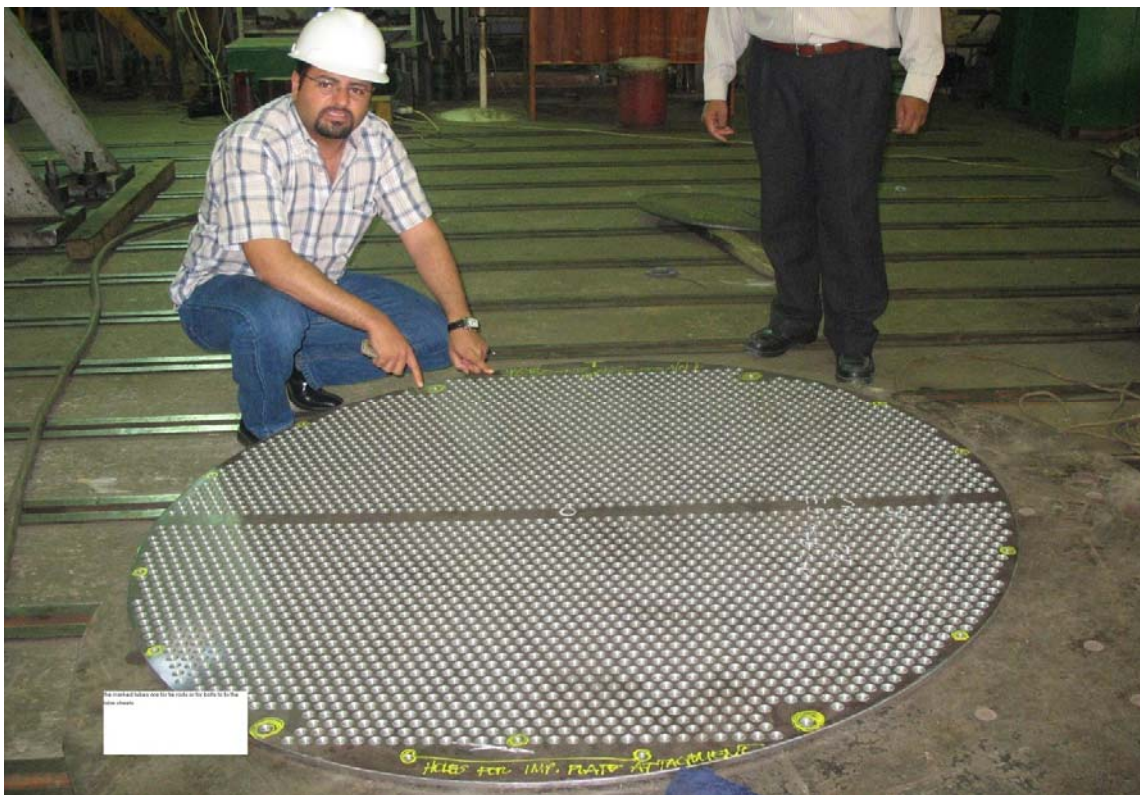
Slika 46. Postupak bušenja razdjelne ploče
