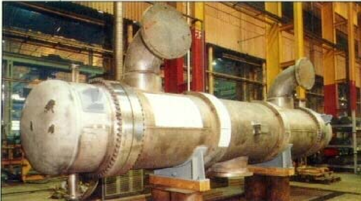
Slika 48. Gotova konstrukcija „Shell and tube“ izmjenjivača topline
