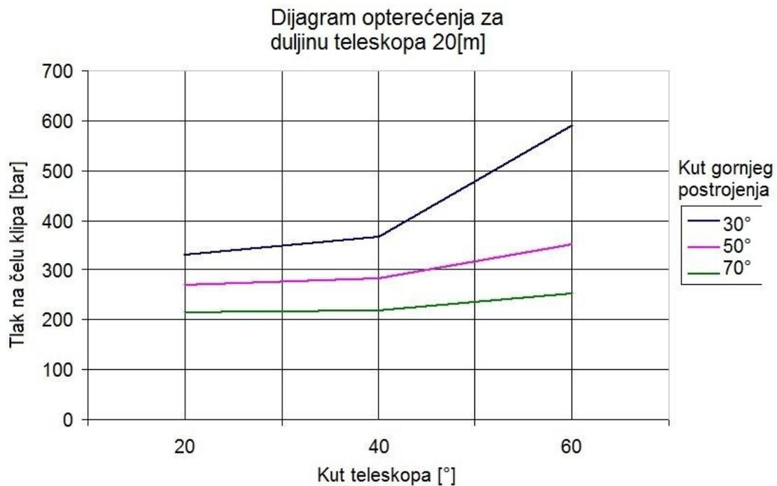
Slika 29. Predodžba opterećenja klipa za duljinu teleskopa 20[m]
