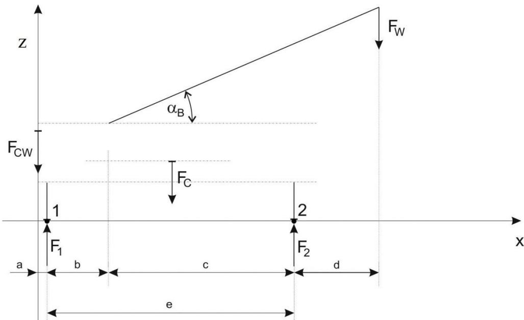
Slika 24. Predodžba sustava projekcije sila u  $(x,z)$  ravnini:  $F_{CW}$ -težina protu-utega,  $F_W$ -težina tereta,  $F_C$ -težina dizalice,  $\alpha_B$ -kut teleskopa,  $F_1$ -prva potporna sila,  $F_2$ -druga potporna sila
