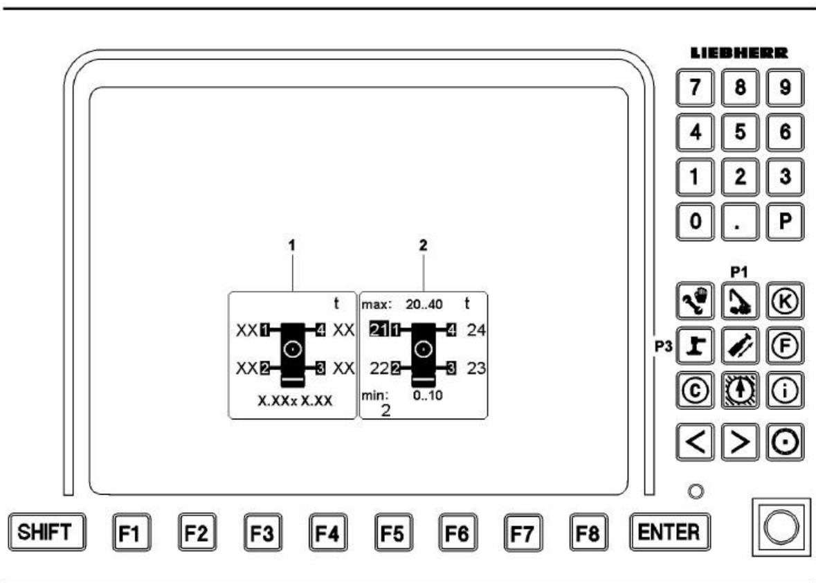
Slika 10. Predodžba programa za prikaz potpornih sila
