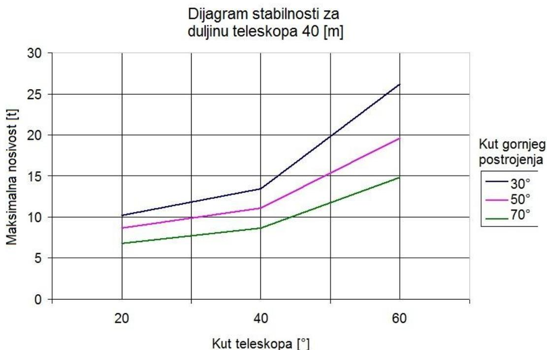
Slika 28. Predodžba dijagrama stabilnosti za duljinu teleskopa 40[m]
