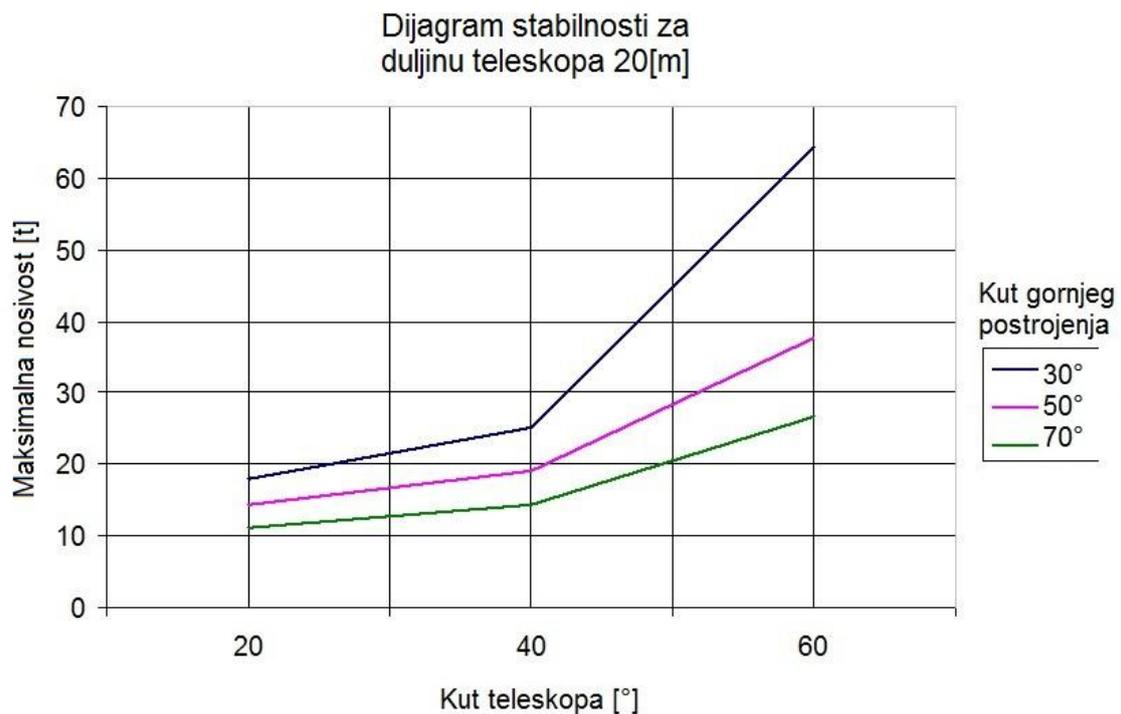
Slika 27. Predodžba dijagrama nosivosti za duljinu teleskopa 20[m]
