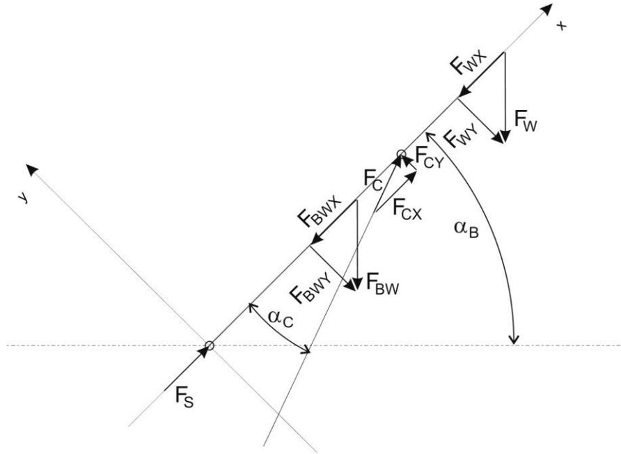
Slika 26. Predodžba sustava projekcije sila teleskopa:  $F_C$ -sila cilindra,  $F_W$ -težina tereta,  $F_B$ -težina teleskopa,  $F_S$ -potporna sila,  $\alpha_B$ -kut teleskopa,  $\alpha_C$ -kut cilindra
