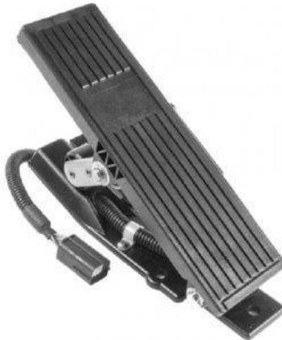
Slika 20. Predodžba pedala senzora
