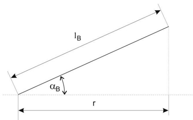
Slika 22. Predodžba teleskopa u ravnini i njegovih parametara:  $l_B$ -duljina teleskopa,  $r$ -radni radijus,  $\alpha_B$ -kut teleskopa.
