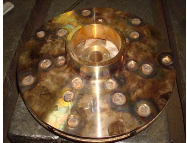
Slika 53. Rotor nakon zavarivanja
