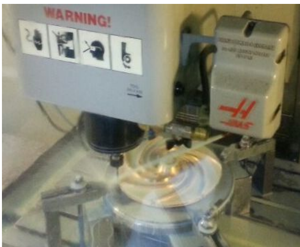
Slika 37. Obrada stražnjeg diska na CNC-u
