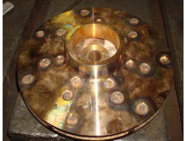
Slika 53. Rotor nakon zavarivanja
