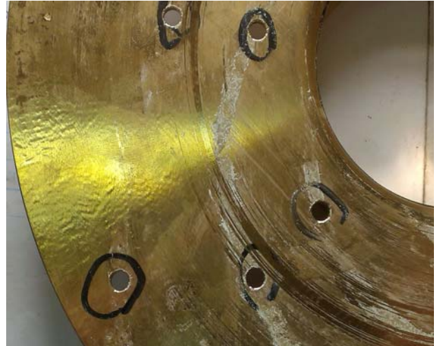
Slika 47. Zabušivanje diska s unutarnje strane
