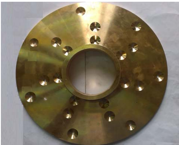
Slika 48. Zabušivanje diska s vanjske strane
