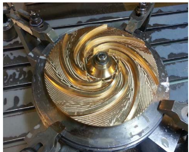
Slika 38. Stražnji disk na CNC-u
