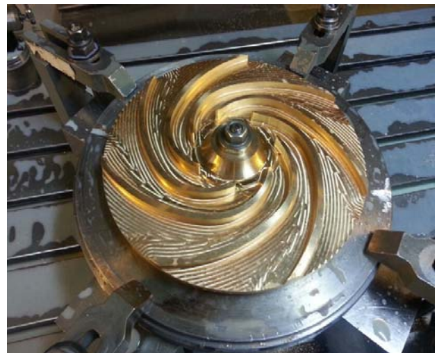
Slika 38. Stražnji disk na CNC-u
