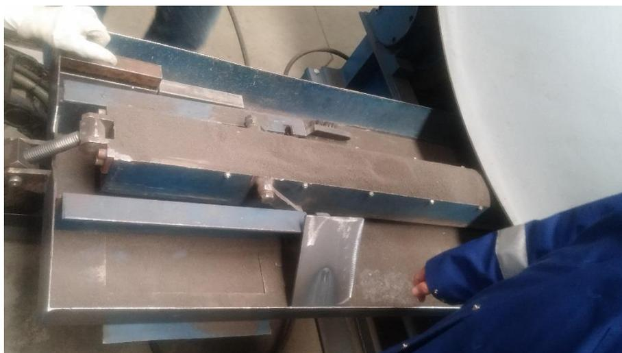
Slika 13. Nečistoća na uređaju za okretanje oplate
