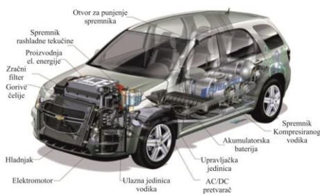
Slika 4.3. Shema sistema rada vozila na vodik.
