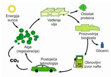
Slika 4.2. Proces nastanka biodizela.
