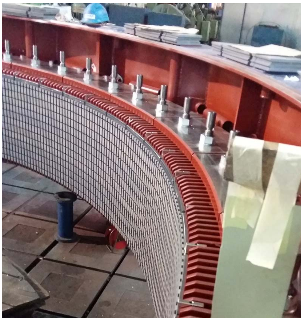
Slika 17. Završno prešanje paketa statora preko matica [9]
