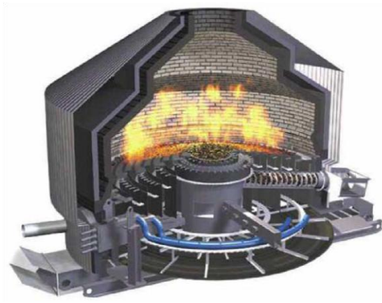
Slika 14. Rotirajuća konična rešetka s donjim dovodom goriva
