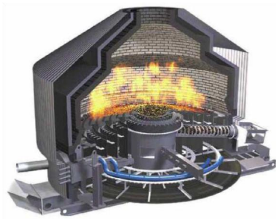
Slika 14. Rotirajuća konična rešetka s donjim dovodom goriva
