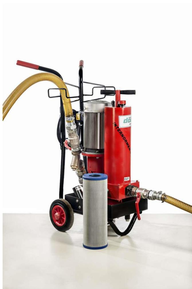
Slika 22. Mobilni filtarski uređaj (za mehaničke nečistoće) [6]
