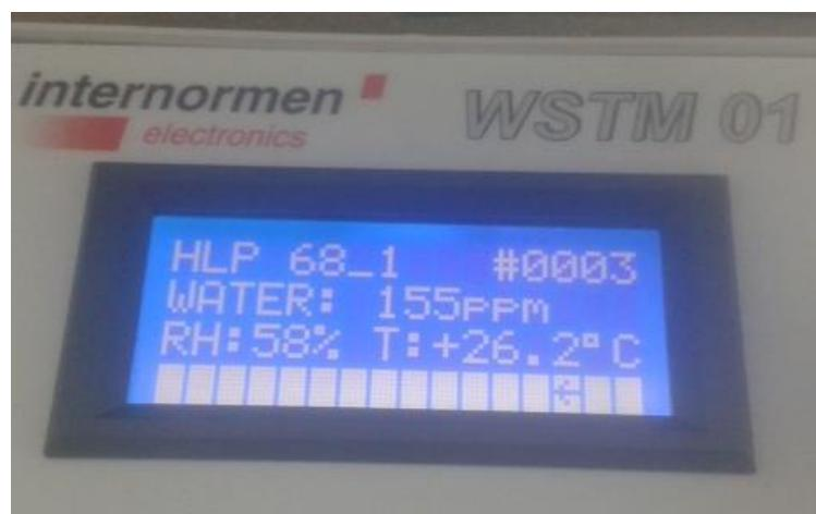
Slika 16. Rezultat mjerjenja količine vode u ulju uređajem WSTM 01
