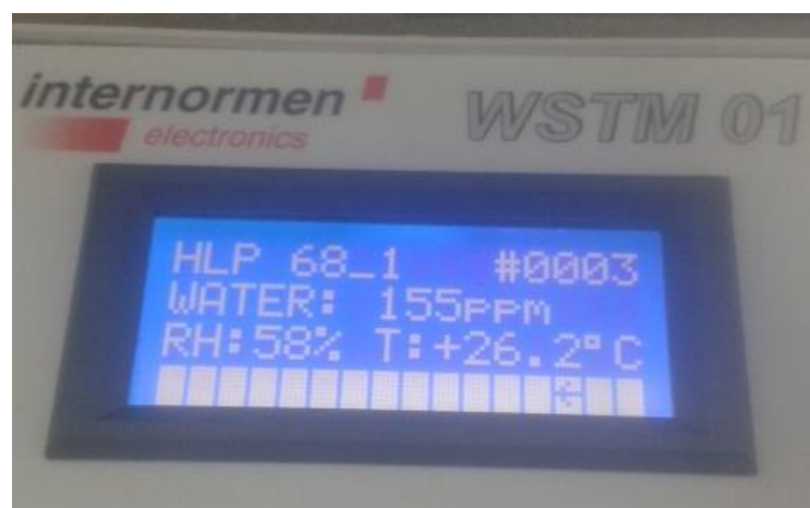
Slika 16. Rezultat mjerenja količine vode u ulju uređajem WSTM 01
