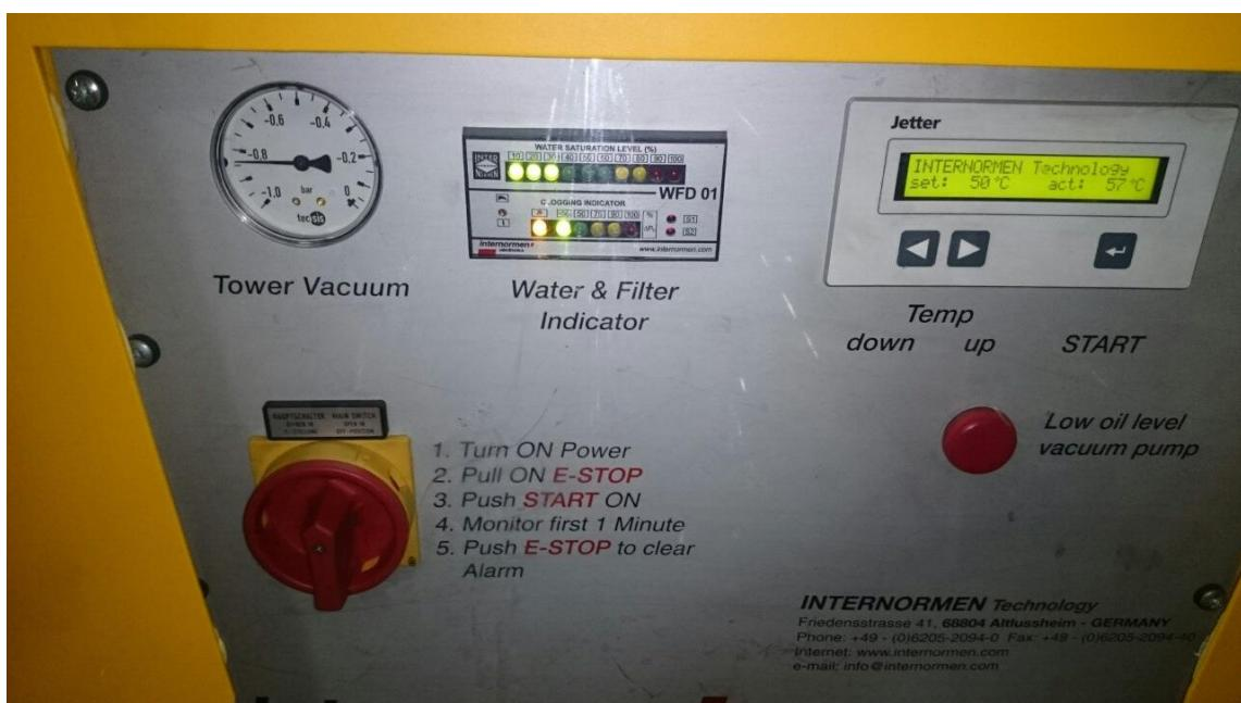
Slika 35. Kontrolna ploča IFPM 21 uređaja s prikazom trenutne postotne zasićenosti vodom, temperature i vakuma (podtlak)
