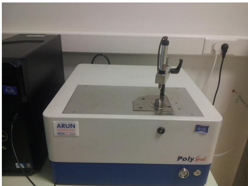
Slika 41 – Uređaj za kemijsku analizu metala "PolySpek"
