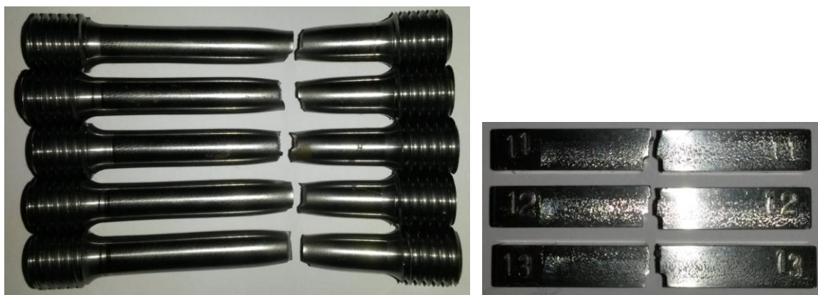
Slika 43 – Uzorci iz materijala Č4141 nakon: a) statičkog vlačnog pokusa b) udarnog rada loma
