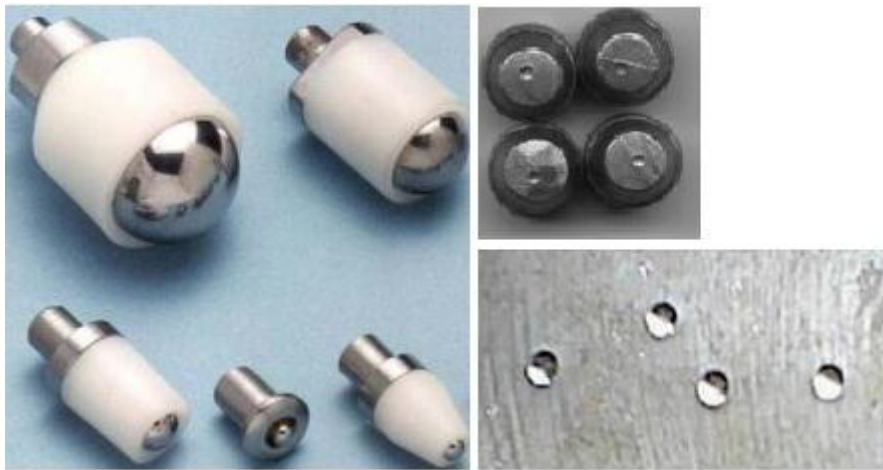
Slika 24 – Izvedbe kuglica kod Brinellove metode i otisci na uzorku [18]
