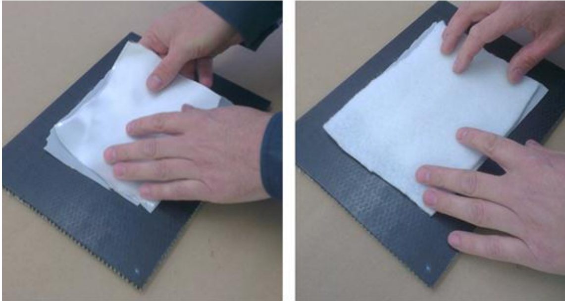
Slika 75. Nanošenje ostalih slojeva vakuumske vrećice.
