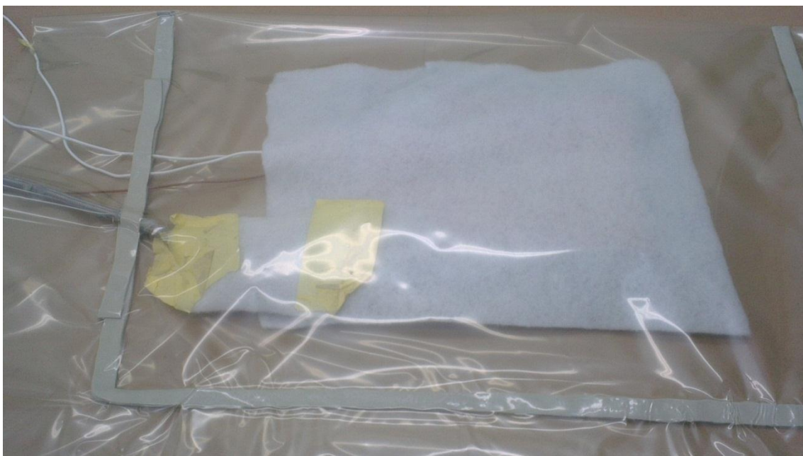
Slika 77. Vakuumiranje podnog zrakoplovnog panela
