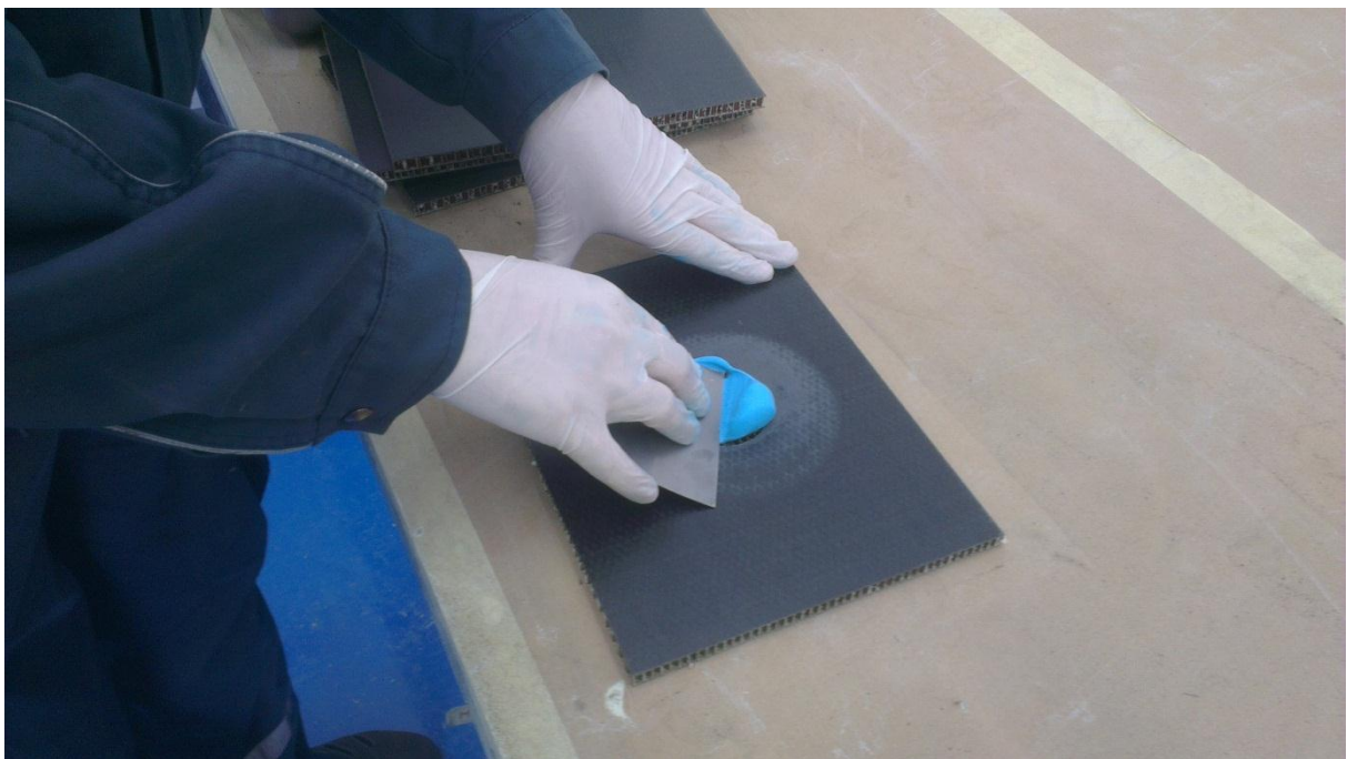
Slika 61. Raspoređivanje pomoću špattle
