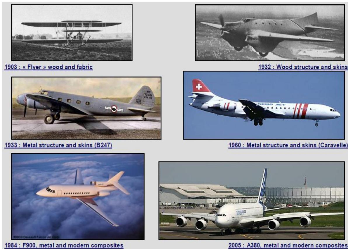
Slika 20. Kronološka primjena materijala u strukturi zrakoplova [3]
