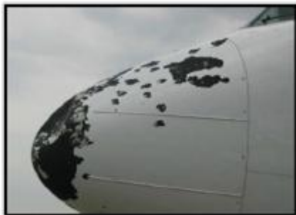
Oštećenje od tuče
