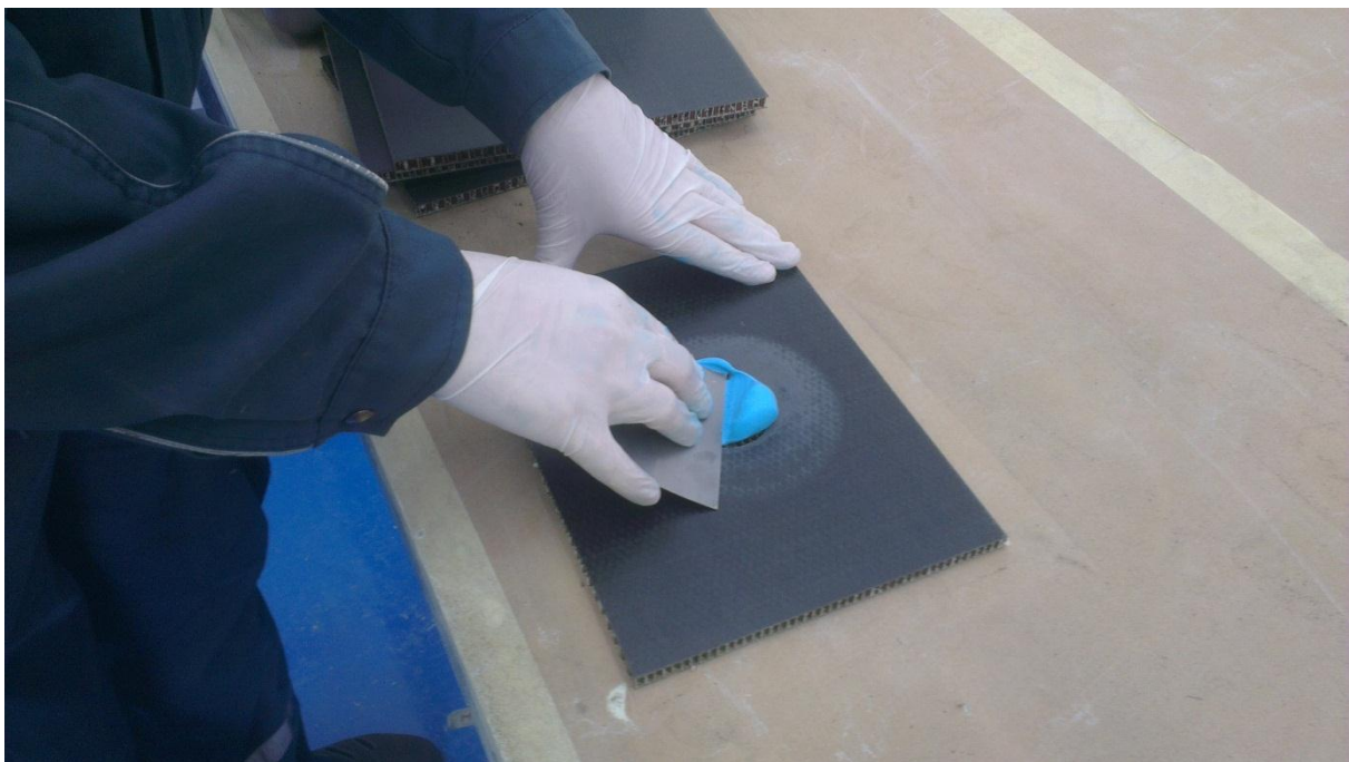
Slika 61. Raspoređivanje pomoću špattle
