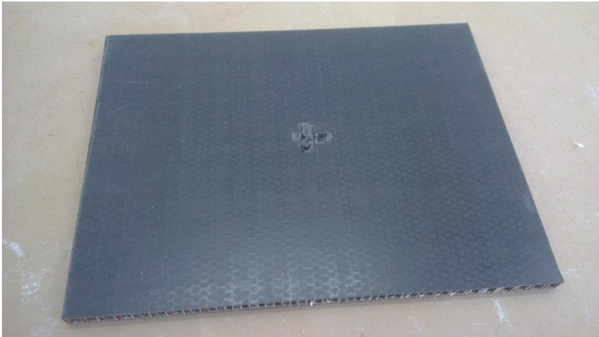
Slika 51. Uzorak podnog panela u zrakoplovu
