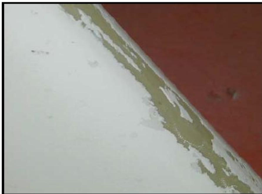
Slika 49. Erozijska šteta na vertikalnom stabilizatoru [3]
