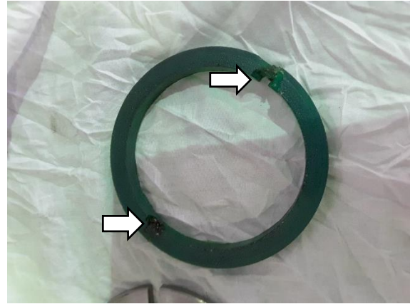
Slika 46 - Oštećenja na polimernom graničniku
