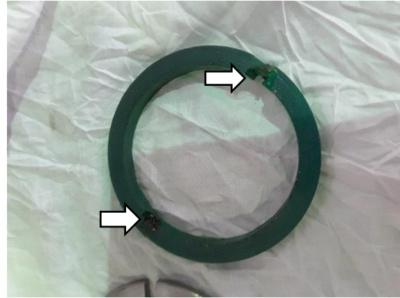
Slika 46 - Oštećenja na polimernom graničniku
