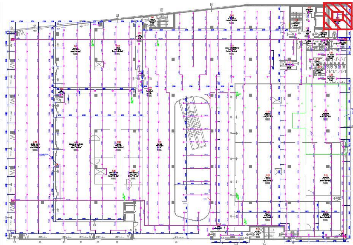
Slika 28. Predodžba prikaza najudaljenije točke – početak proračuna
