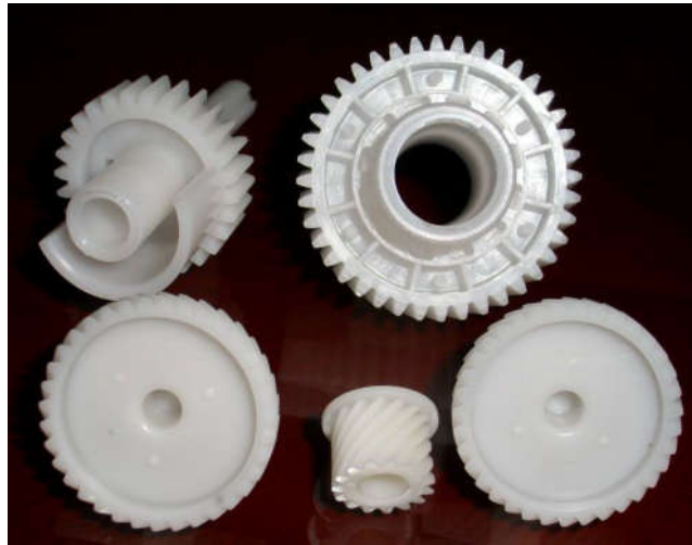
Slika 34. Izrada zupčanika od polioksimetilena[23]
