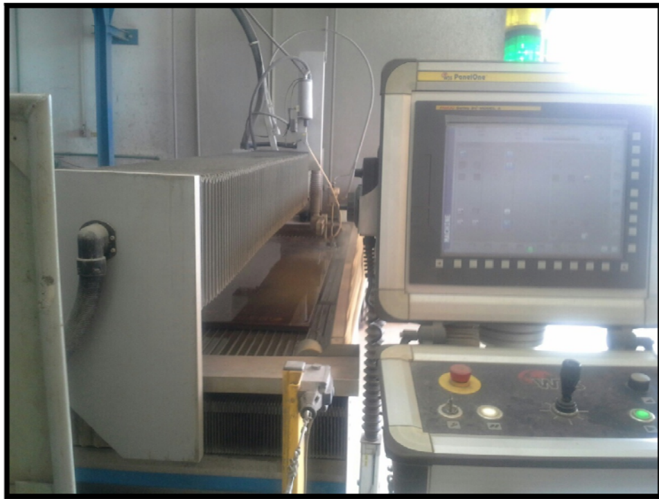
Slika 9.1. Izrezivanje prirubnica na stroju NC 3015 EB
