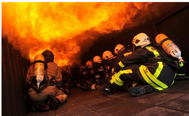
Slika 16. Flashover u simulatoru na kruta goriva [6]
