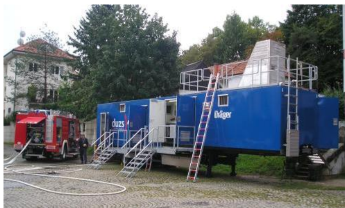
Slika 12. Fire Dragon III – plinski simulator [6]
