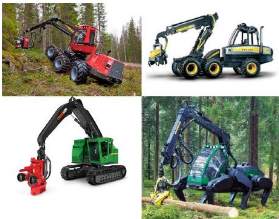
Slika 4. Kotačni, gusjenični i hodni harvester (izvori: www.loggingon.net , www.ponsse-austria.com , www.deere.com , www.flickr.com 2016.)
