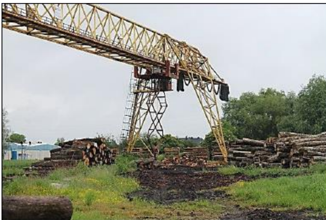
Sl. 16. Portalna dizalica za prenošenje trupaca do pilane [1]
