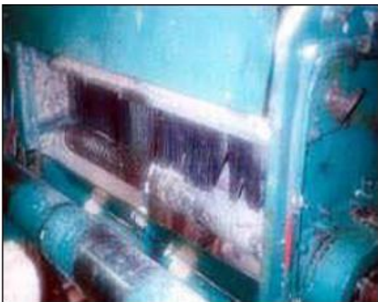
Sl. 23. Neispravan (oštećen) zaštitni uređaj za sprečavanje povratnog udarca [1]
