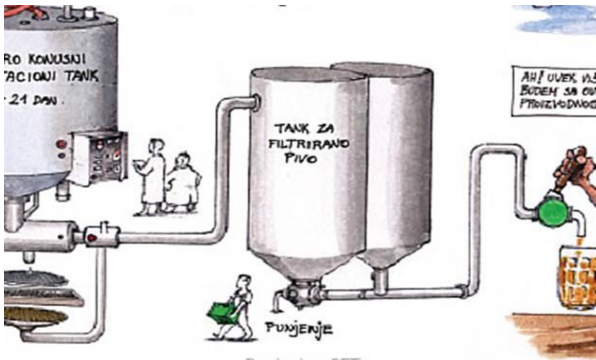
Slika 7. Završni dio procesa proizvodnje piva
