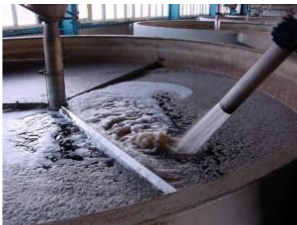
Slika 5. Dodavanje vode u kotao sa sladom
