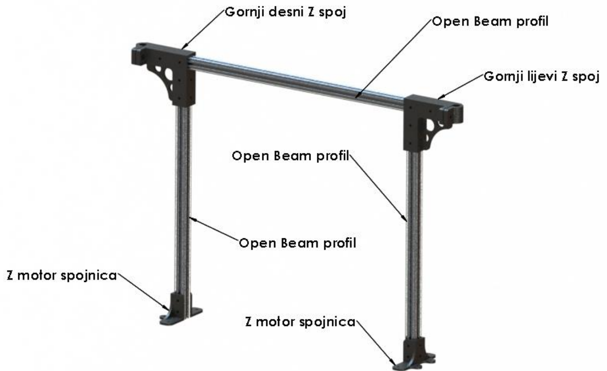
Slika 31. Sklop vertikalnog dijela noseće konstrukcije
