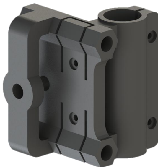
Slika 36. Nosač remenice i ležaja X osi
