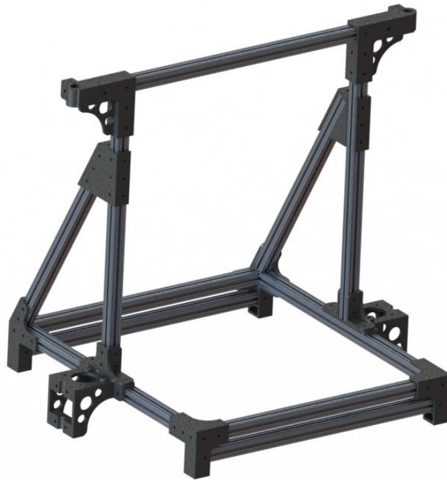
Slika 33. Sklop cjelokupne konstrukcije 3D printera
