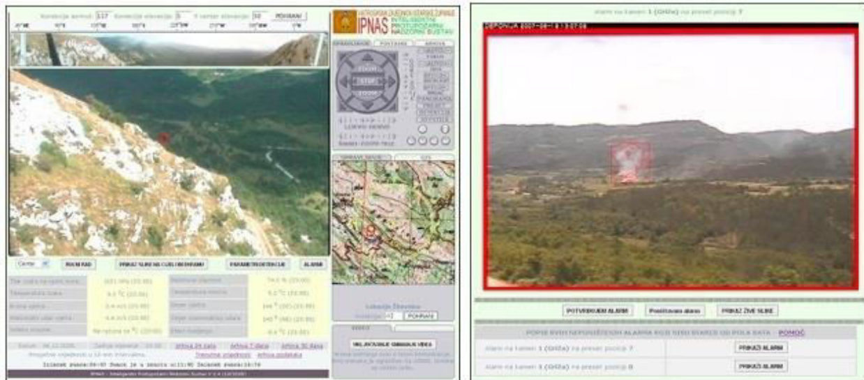
Sl. 14. Ekran ručnog rada sustava IPNAS i primjer tipičnog alarmnog prozora (lokacija Buzet, Istra 2007). [2]
