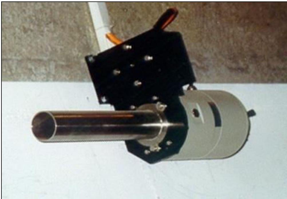
Sl. 14. Uređaj za mjerjenje CO i vidljivosti [8]
