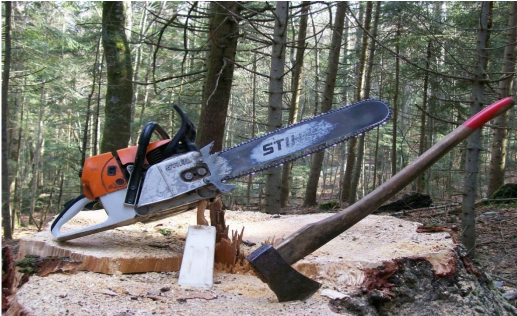
Slika 16. Prikaz motorne pile, sjekire i klina
