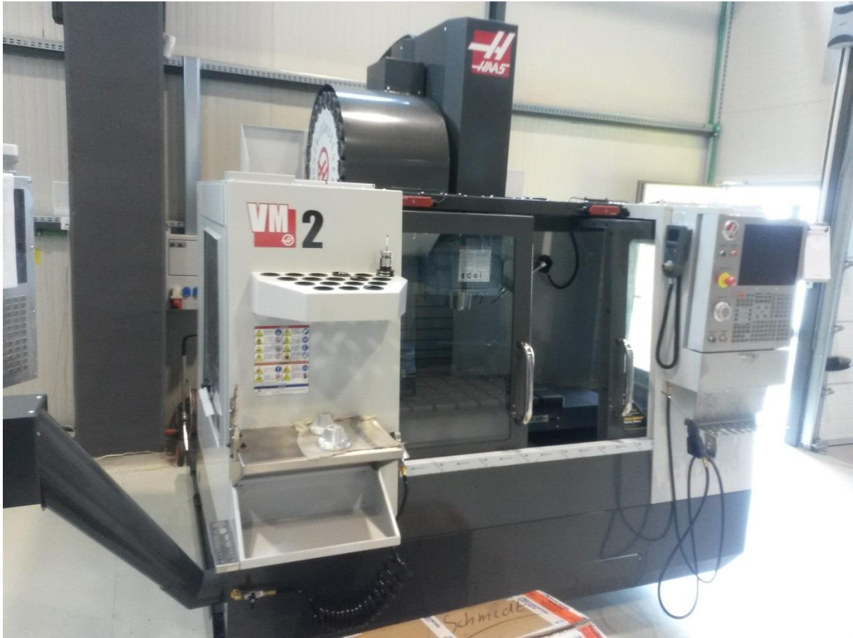
Slika 14. HAAS Glodalica VM2
