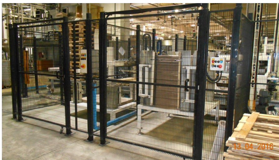
Slika. 7. Zaštita od metalne šipke
