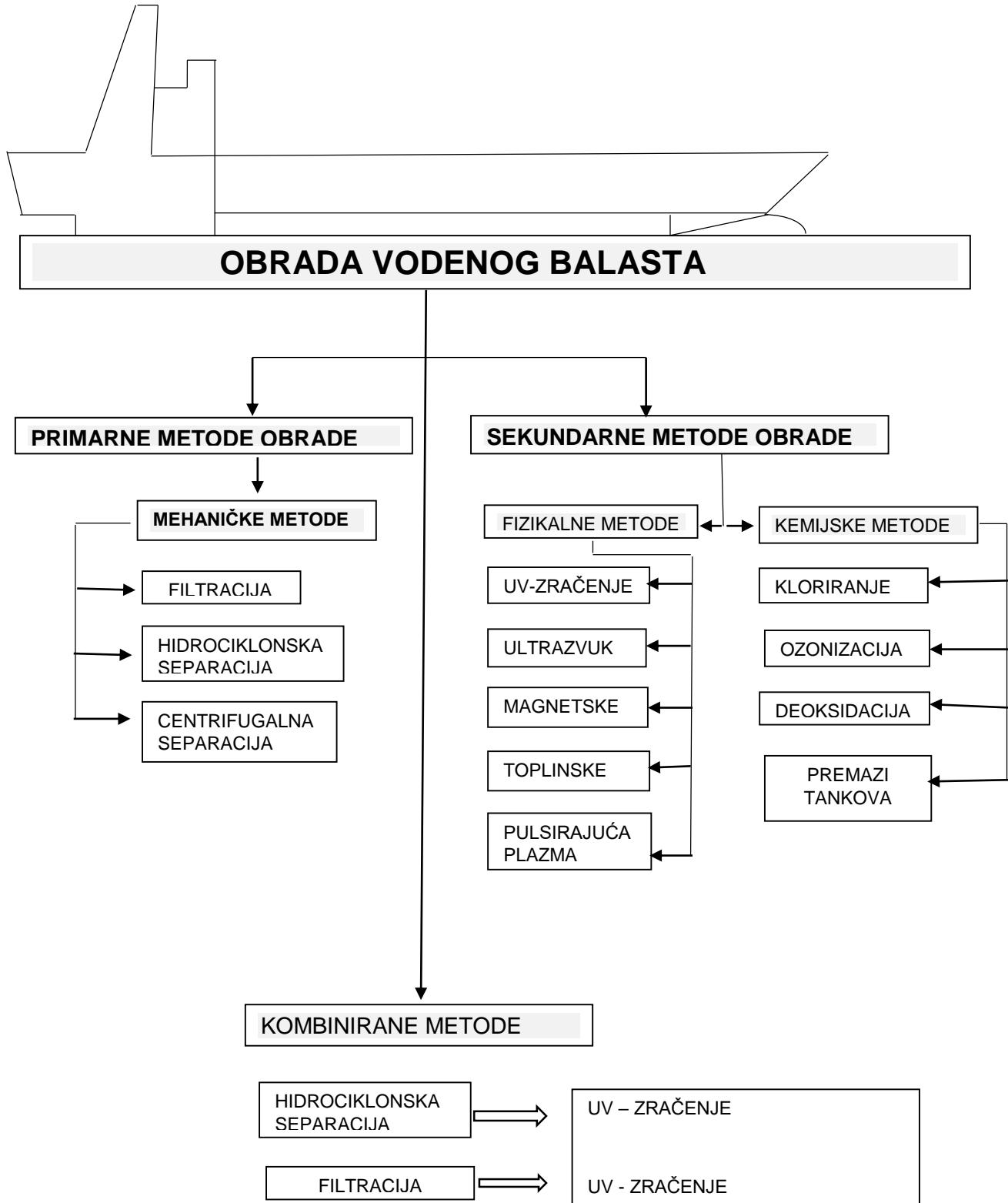
Slika 9. Podjela metoda obrade vodenog balasta na brodu
