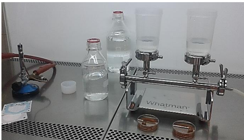
Slika 9. Sistem za membransku filtraciju (Autor: Neda Carević, 21.06.2016.)
