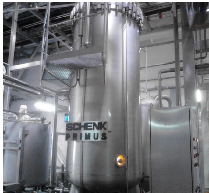
Slika 3. Naplavni filter. Izvor: vlastita fotografija
