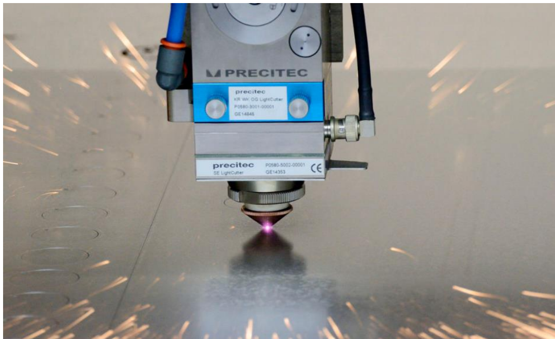
Slika 9. PRETITEC GE-14845 laserska glava u obradi
