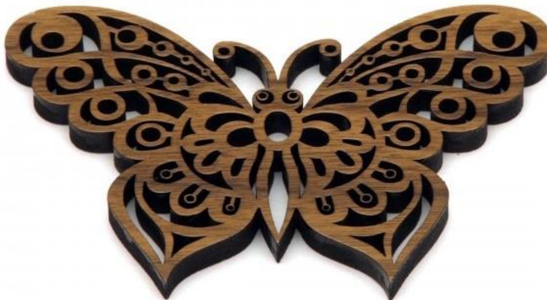
Slika 15. Prmjer laserske obrade sječenjem i prosjecanjem
