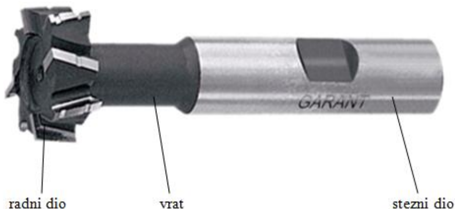
Slika 8. Elementi glodala
