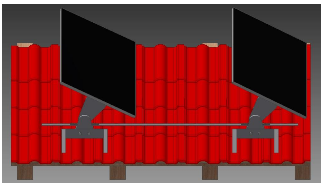
Slika 24. Predodžba zakreta solarnog sustava za 30° (izvorno)
