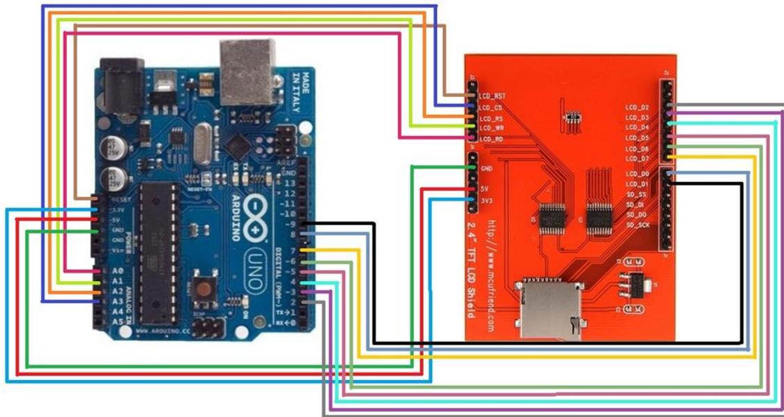
Slika 11. Predodžba povezivanja LCD ekrana na Arduino ploču
