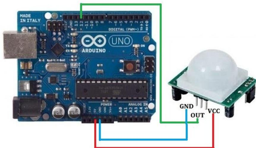
Slika 13. Predodžba spajanje osjetila pokreta sa Arduino pločom
