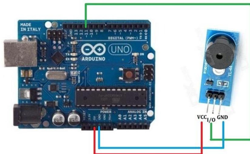
**Slika 12. Predodžba povezivanja beepera na Arduino ploču**
