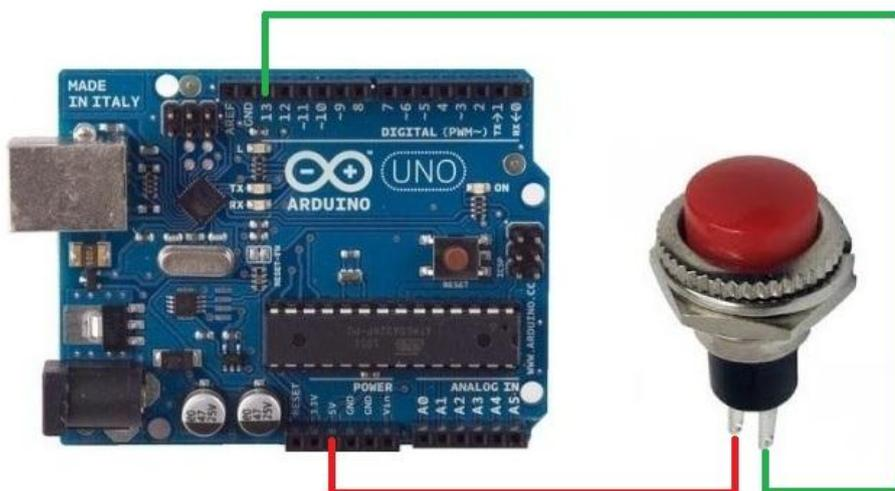
Slika 16. Predodžba spajanja tipkala
