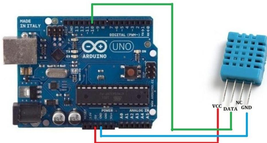
**Slika 14. Predodžba spajanja osjetila temperature na Arduino ploču**
