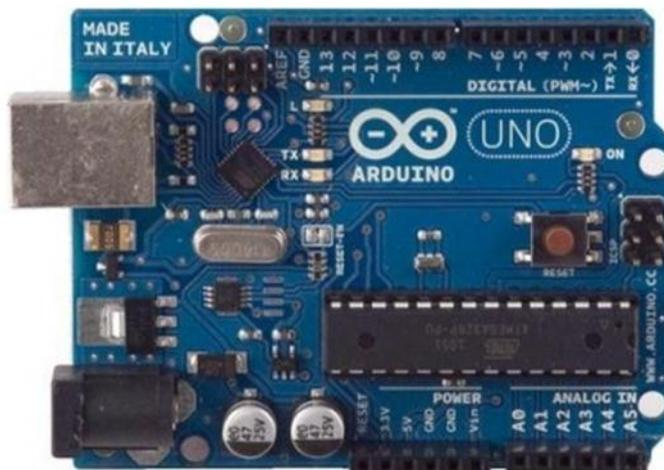
Slika 1. Predodžba Arduino Uno ATmega328 mikrokontroler ploče
