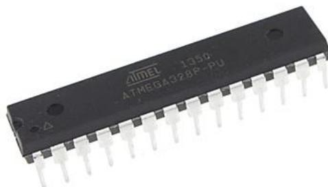
Slika 3. Predodžba mikrokontrolera ATmega328
