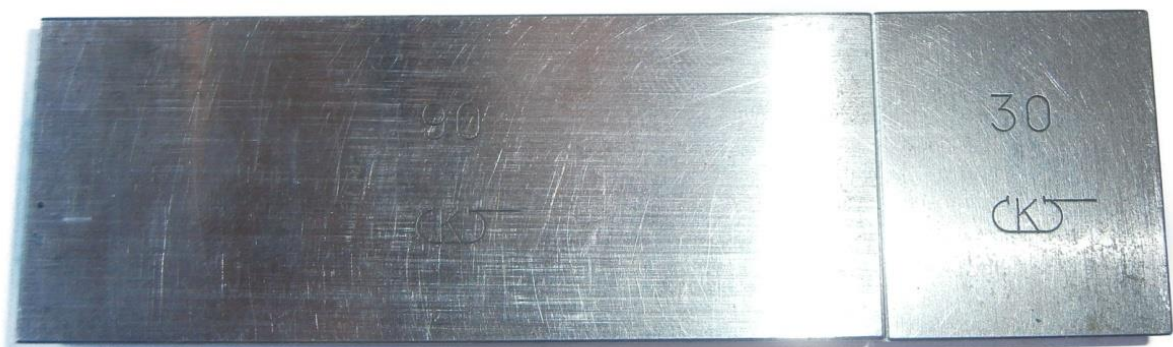
Slika 45. Spajanje dvaju etalona 120 mm
