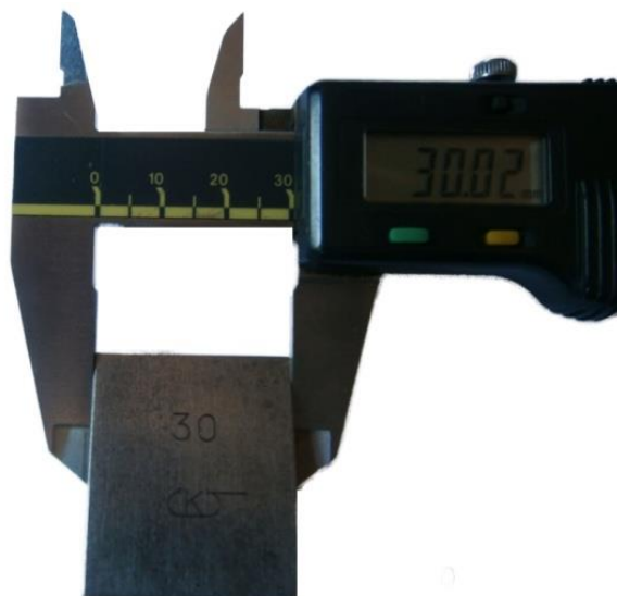
Slika 43. Drugo mjerenje etalona od 30 mm
