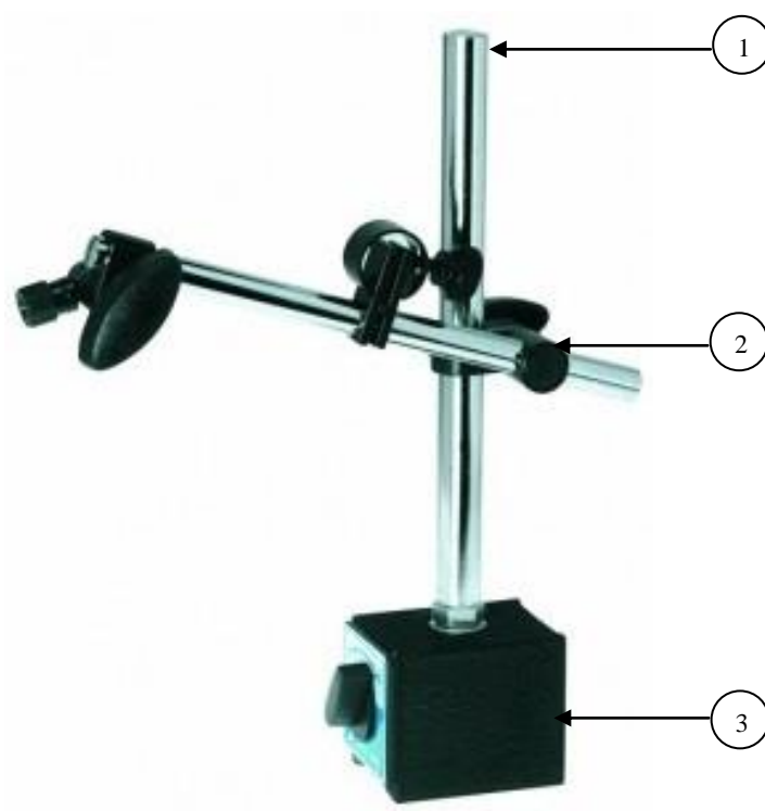
Slika 33. Držač za mjernu uru, magnetni stalak [21]
