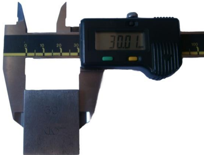
Slika 42. Prvo mjerenje etalona od 30 mm
