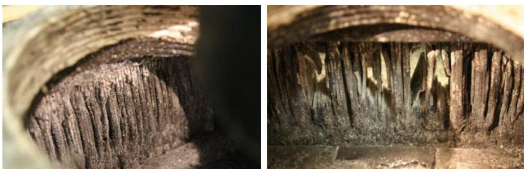
**Slika 35:** Metalne pločice hvatača plamena (iznutra) [20].
