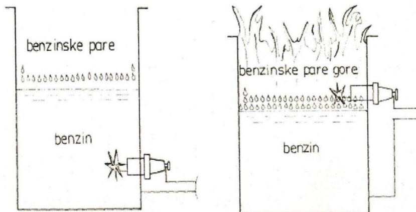
**Slika 2:** Ako u posudu koja sadrži benzin ugradimo automobilsku svjećicu ispod razine benzina i pustimo električnu struju između krajeva elektroda, stvoriti će se električna iskra, ali se benzin neće zapaliti (lijevo). Međutim, ako istu svjećicu ugradimo neposredno iznad razine benzina gdje se nalaze benzinske pare i zrak, smjesa će se odmah zapaliti čim se na kraju elektroda pojavi električna iskra [14].
