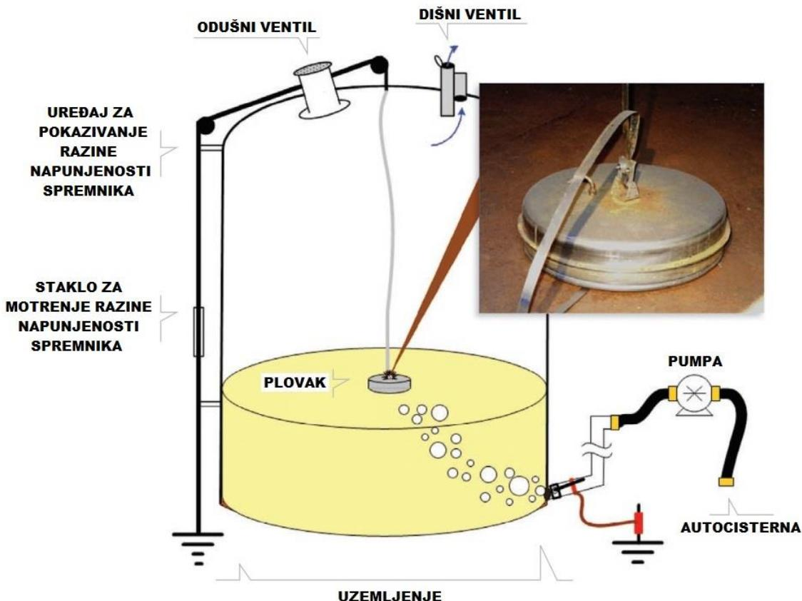
Slika 36: Spremnik s otapalom i fotografija primjera plovka [19].
