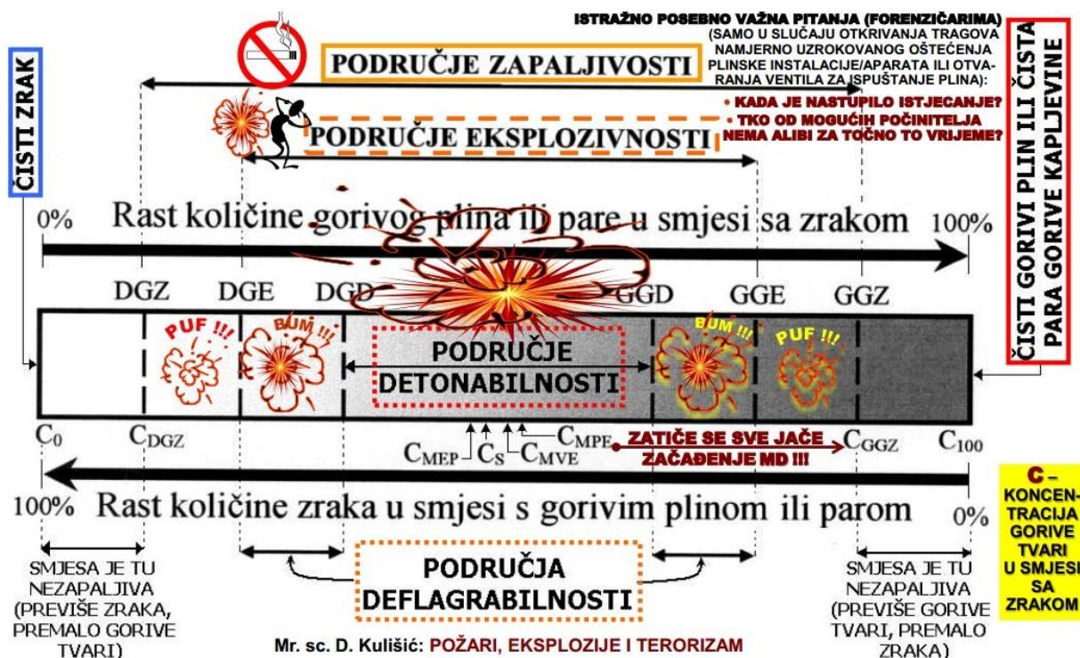
Slika 3: Područje zapaljivosti, eksplozivnosti, deflagrabilnosti i detonabilnosti [11].
