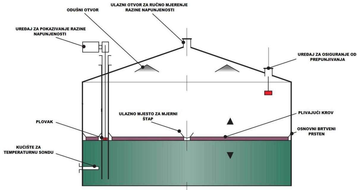
Slika 20: Skica presjeka nadzemnog spremnika s plivajućim krovom [7].
