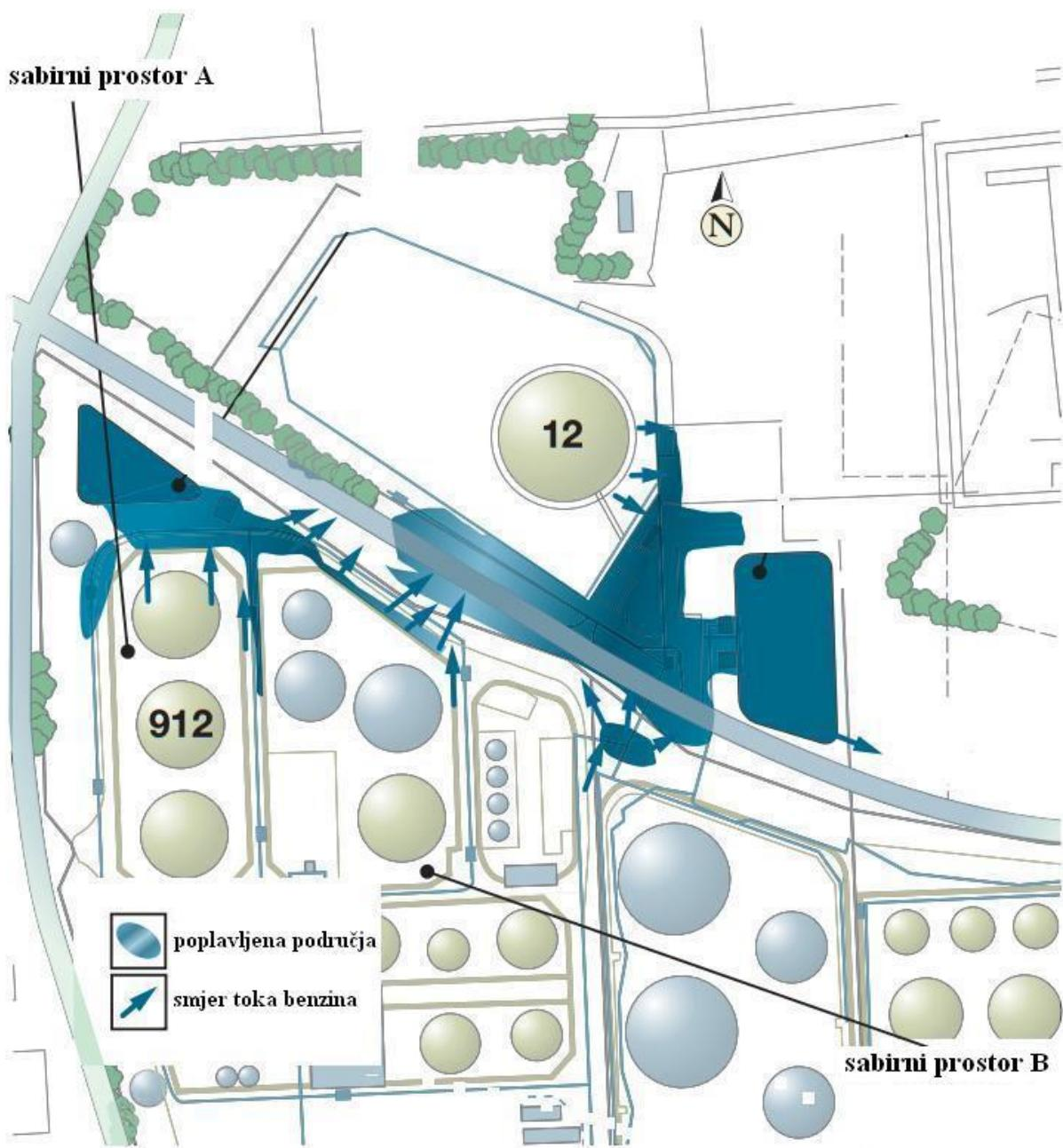
Slika 21: Prikaz smjerova curenja benzina i poplavljenih dijelova u sekciji *HOSL Zapad* [6].
