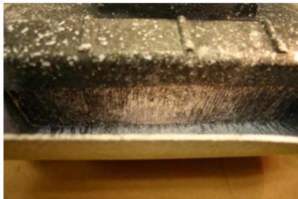
**Slika 34:** Metalne pločice hvatača plamena (izvana) [20].
