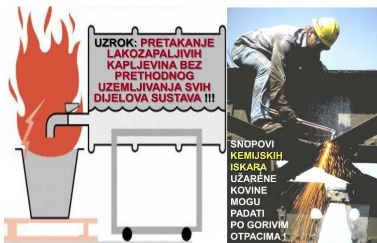
Slika 5 (lijevo): Pripalno djelovanje izboja statičkog elektriciteta prilikom utakanja zapaljive kapljevine bez prethodnog uzemljivanja svih dijelova sustava [11].
