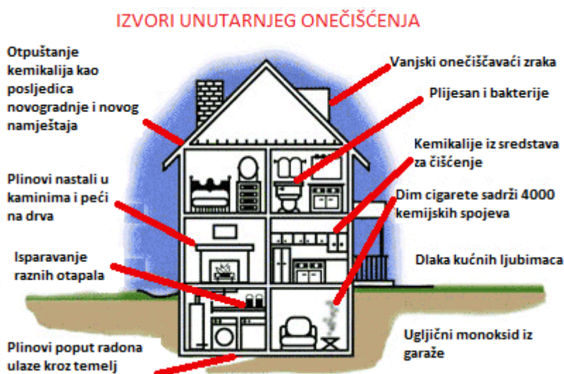
Slika 1. Predodžba izvora unutarnjeg onečišćenja zraka
