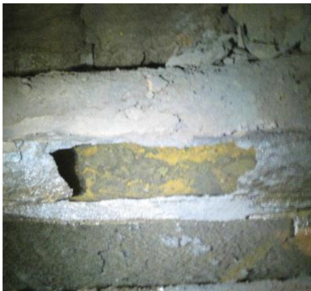
Slika 11. Rupa u cjevovodu nakon nesreće [14].
