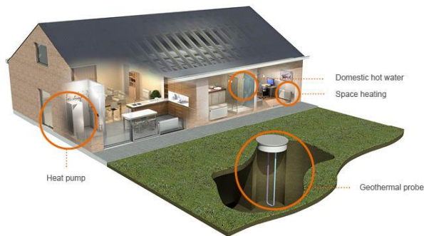
Slika 2. Prikaz korištenja geotermalne energije u kućanstvu
