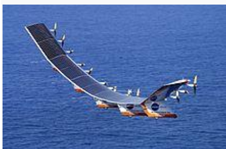
Slika 13. Helios (grč. Sunce) bespilotna letjelica pri letu na sunčev pogon.
