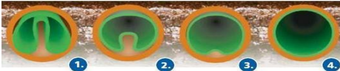
SI. 6. Ugradnja nove cijevi [3]
