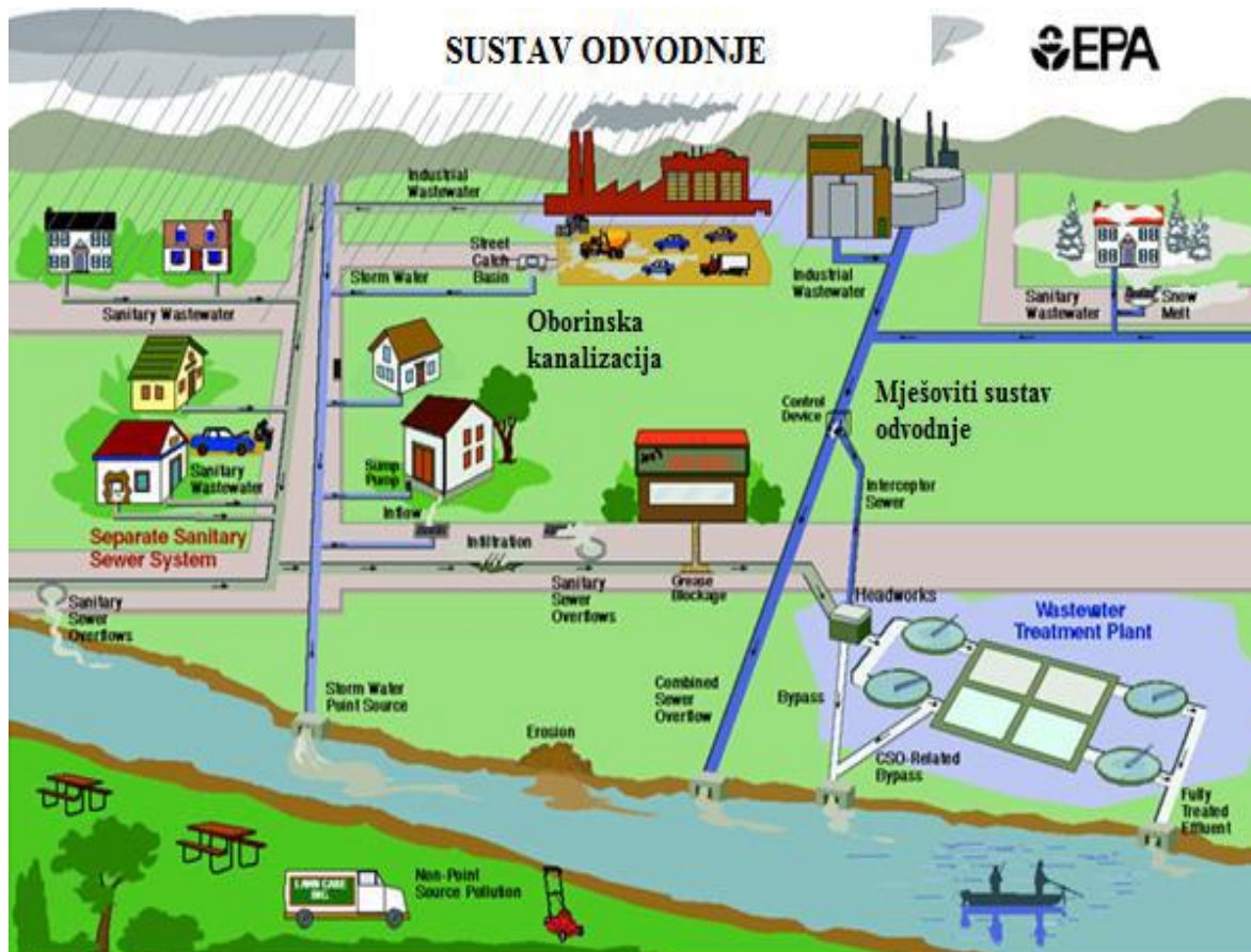
SI. 1. Sustav odvodnje [1]
