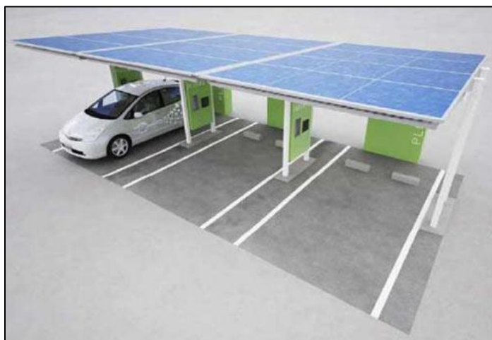
Slika 3.3.3.: Izvedba punionice kao solarne nadstrešnice
