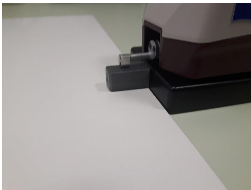
Slika 31. Mjerenje hrapavosti epruvete.
