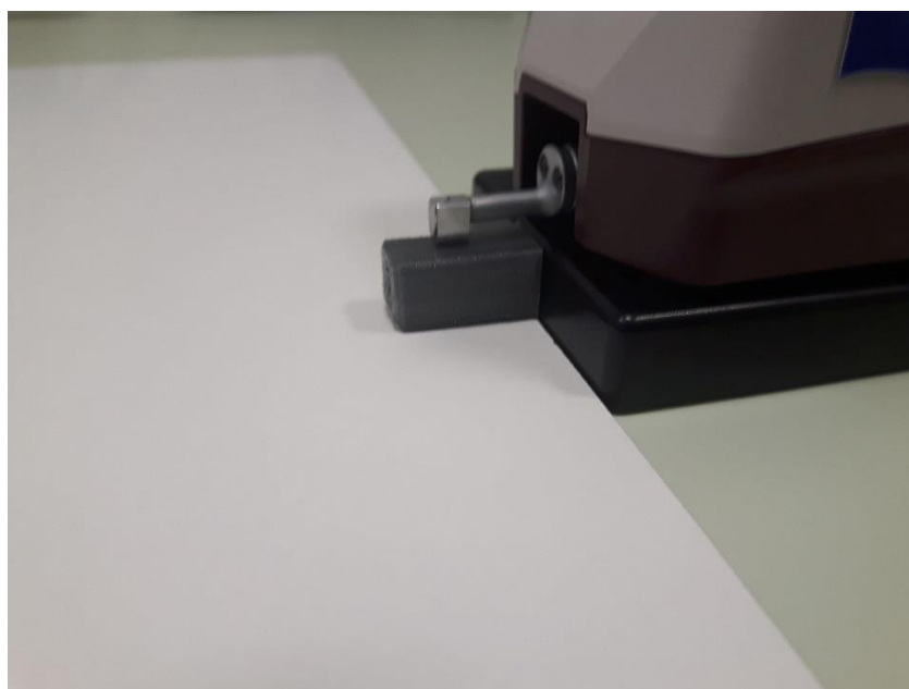
Slika 31. Mjerenje hrapavosti epruvete.
