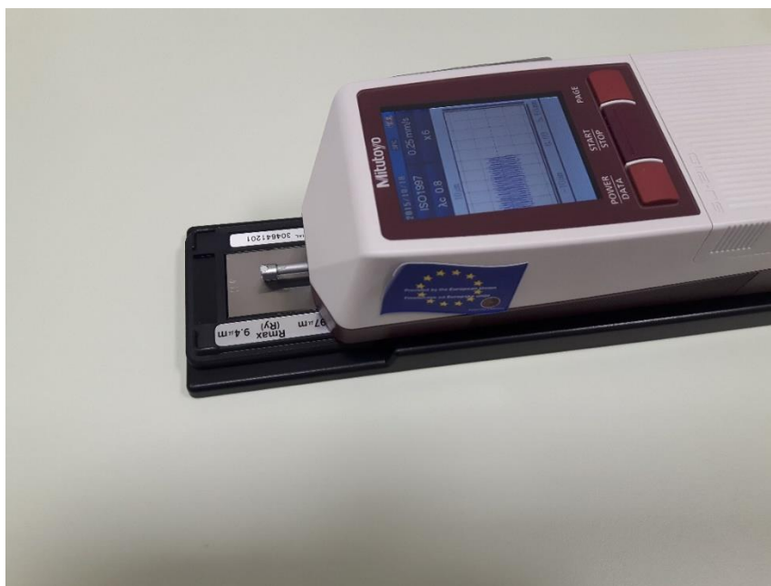
Slika 30. Prikaz kalibracije mjernog uređaja pomoću odgovarajućeg etalona.
