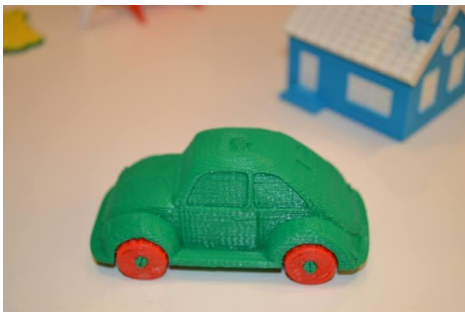
Slika 8. Maketa auta izrađena FDM postupkom. [8]
