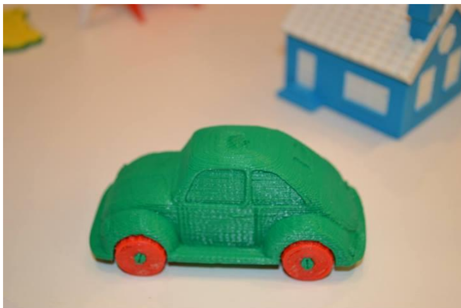
Slika 8. Maketa auta izrađena FDM postupkom. [8]
