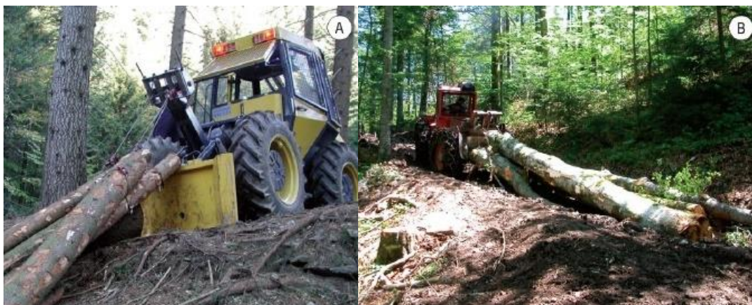
Slika 3. Sakupljanje i privlačenje drva skiderom (izvor: http://hrcak.srce.hr/161587/ 2016.)
