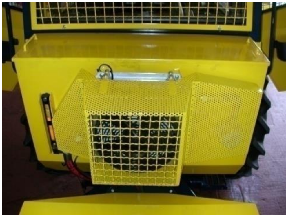
Slika 18. Štitnik ventilatora i kućište [1]
