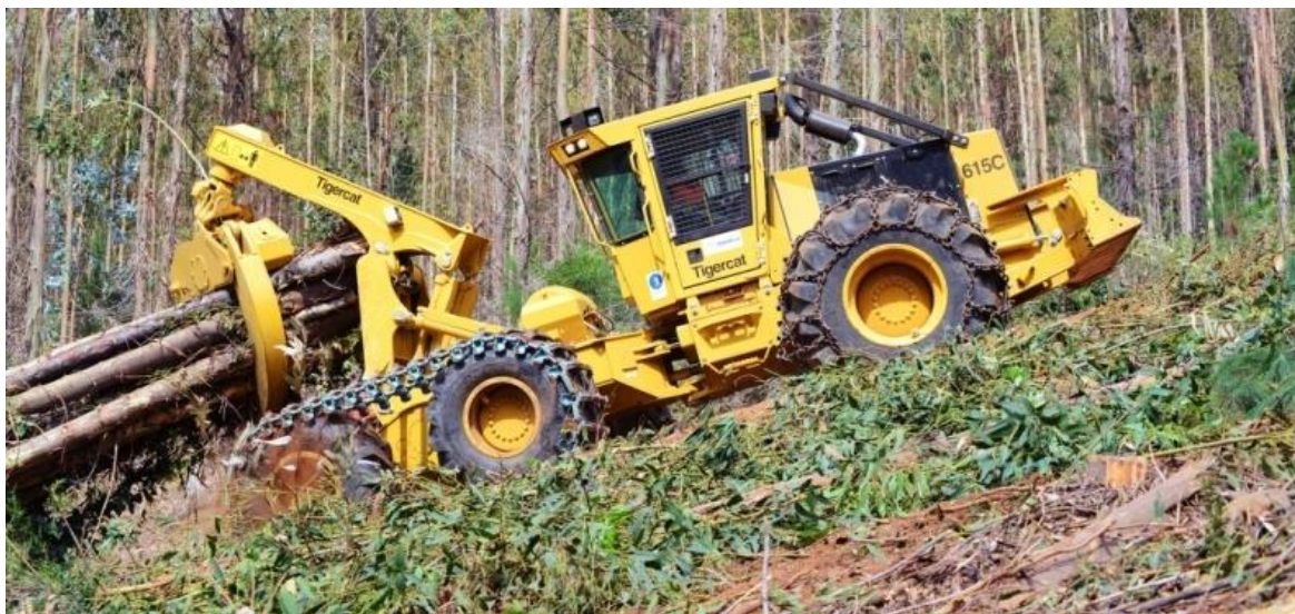
Slika 2. Privlačenje drva na nagnutim terenima (izvor: http://www.bobcatcentral.com/2016 .)
