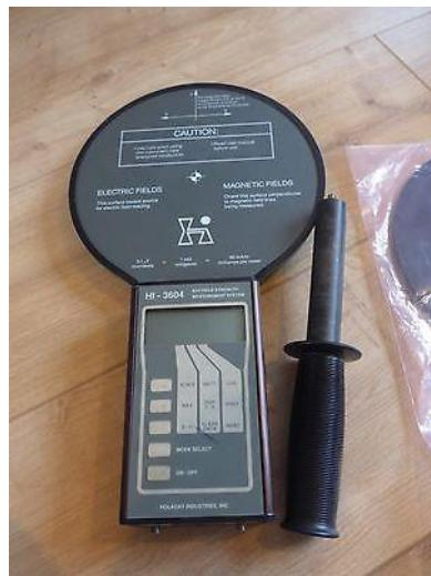
**Slika 7. Uređaj za mјerenje jakosti električnih i magnetskih polja**
