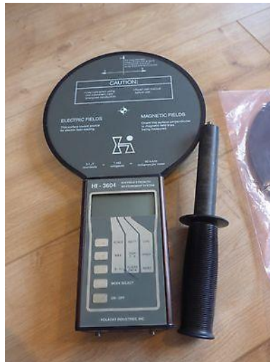
Slika 7. Uređaj za mjerenje jakosti električnih i magnetskih polja
