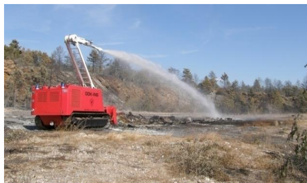
Sl. 14. Samohodno gusjenično vozilo DOK-INGMVF-5 [24]
