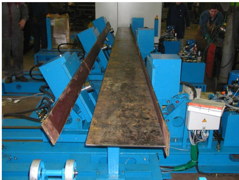
Slika 1.27. Uređaj za oblikovanje profila
