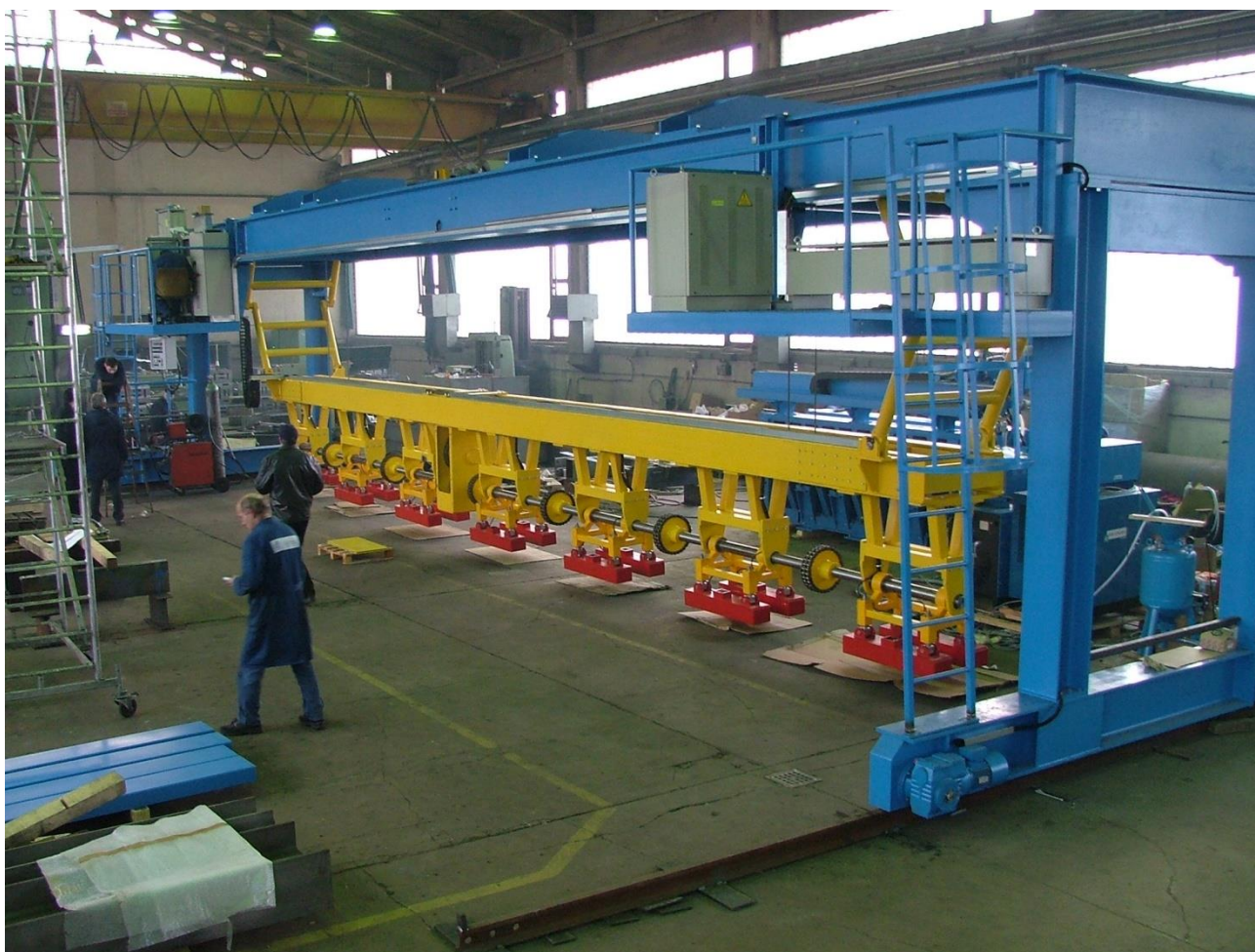
Slika 1.32. Portalna magnetska dizalica - montaža
