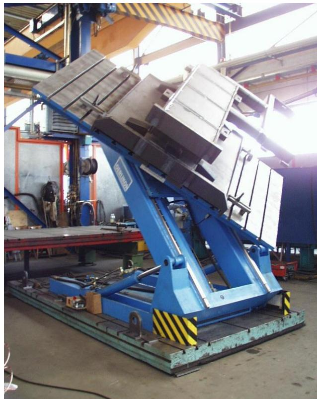
*Slika 1.9. Pozicioner za montažu i zavarivanje 3 t*
