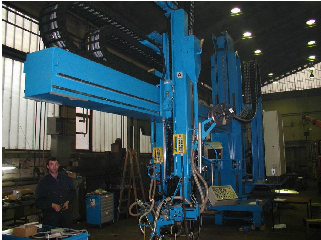
Slika 1.16. „Jednoruki“ nosač automata, EPP oprema
