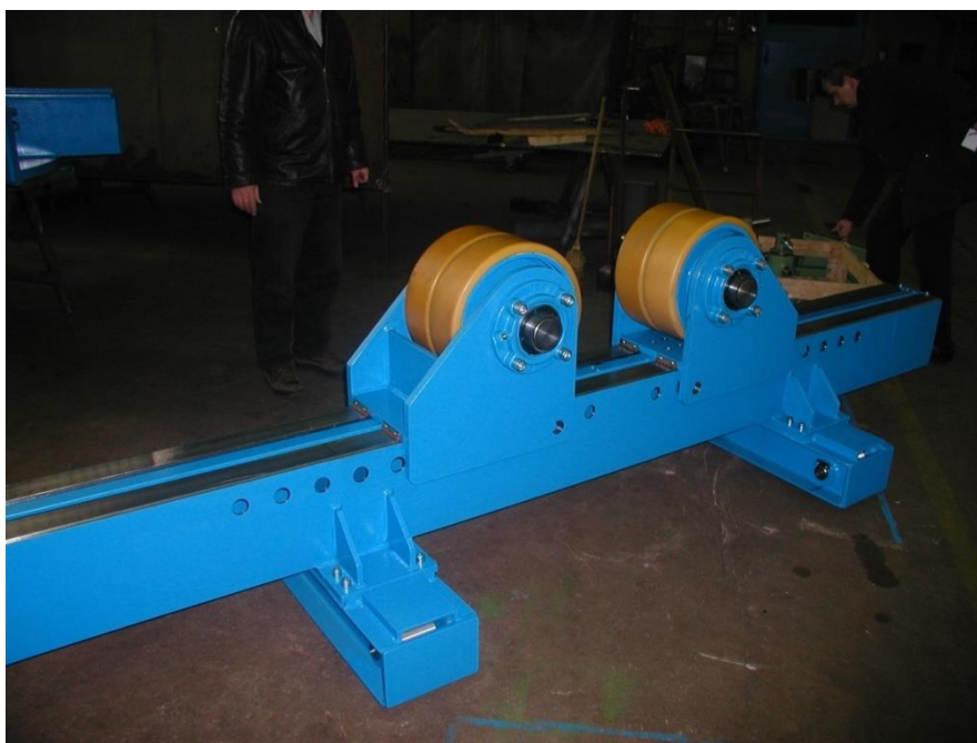
Slika 1.2. Slobodna jedinka 30 t okretaljke, vulkolanski kotači
