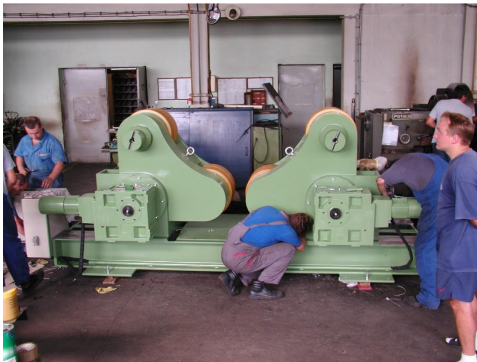
Slika 1.3. Pogonska jedinka samopodesive okretaljke 50 t, stabilna izvedba
