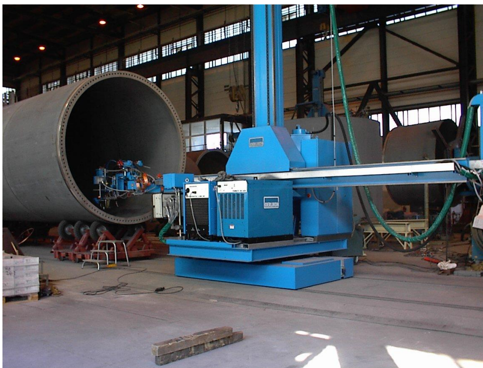
Slika 1.14. Nosač automata s EPP glavom
