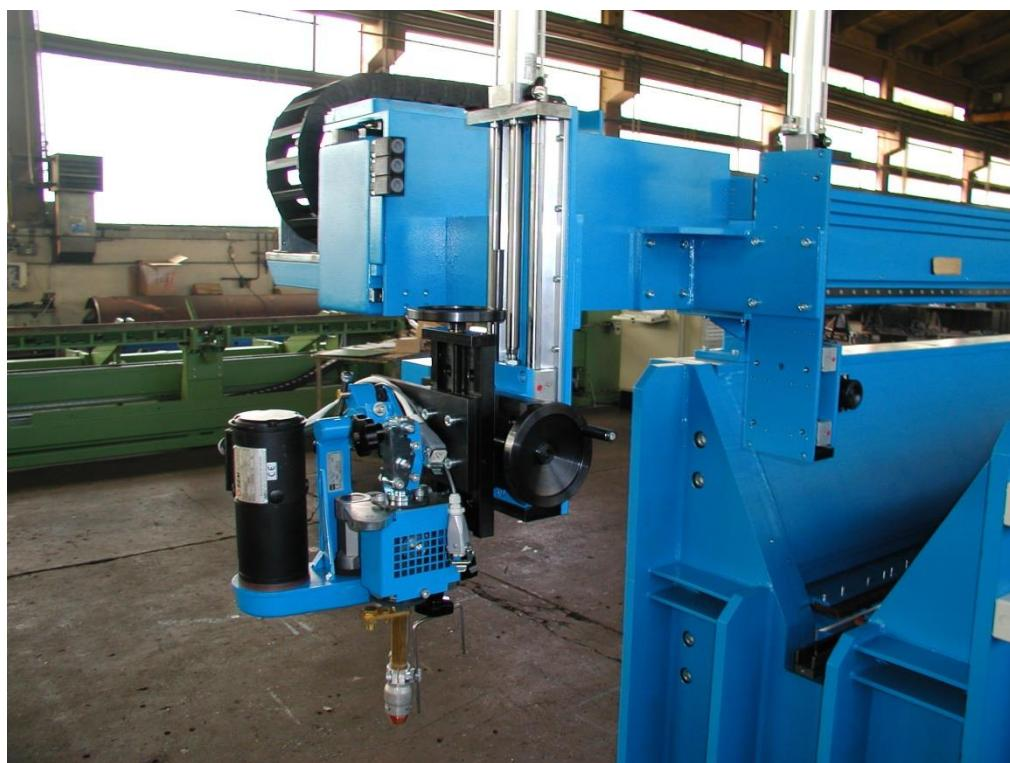
Slika 1.21. Uredaj za uzdužno stezanje i zavarivanje (r.lim 15÷40 mm, TIG+EPP)
