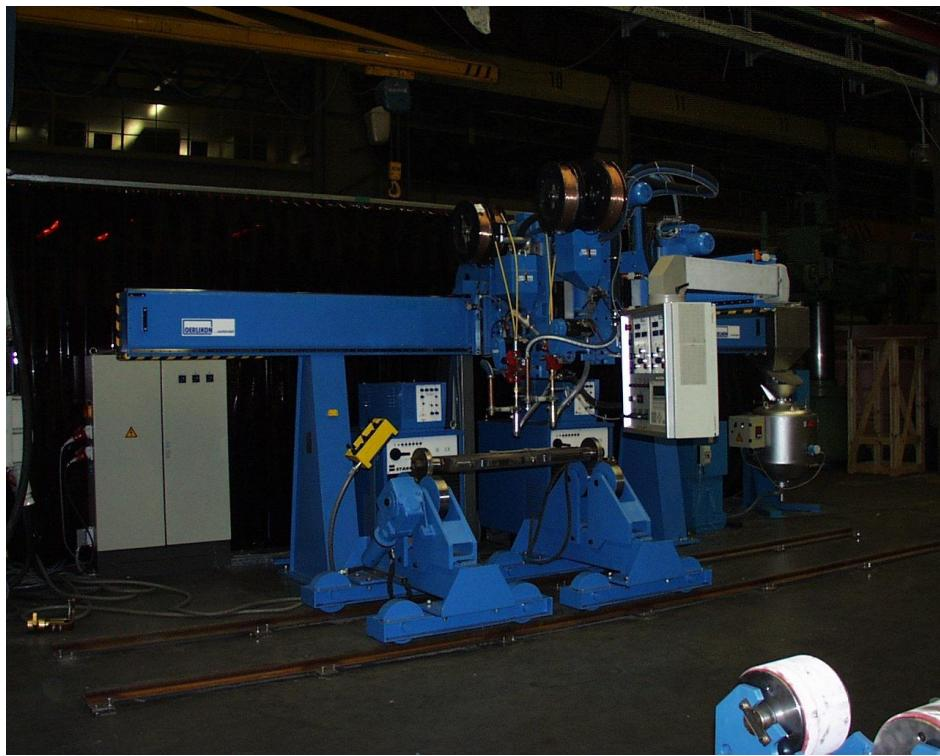
Slika 1.17. „Uzdužni“ nosač automata s EPP opremom za zavarivanje osovina
