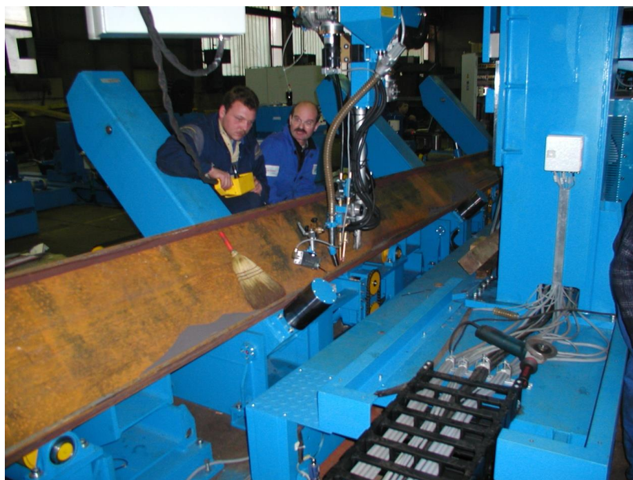
Slika 1.29. Linija za zavarivanje (EPP tandem)
