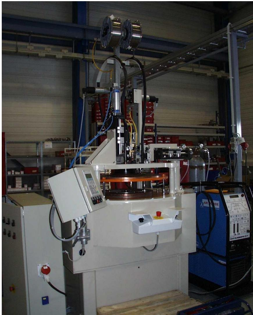
*Slika 1.26. Automat za zavarivanje filter-elemenata, 2xTIG*
