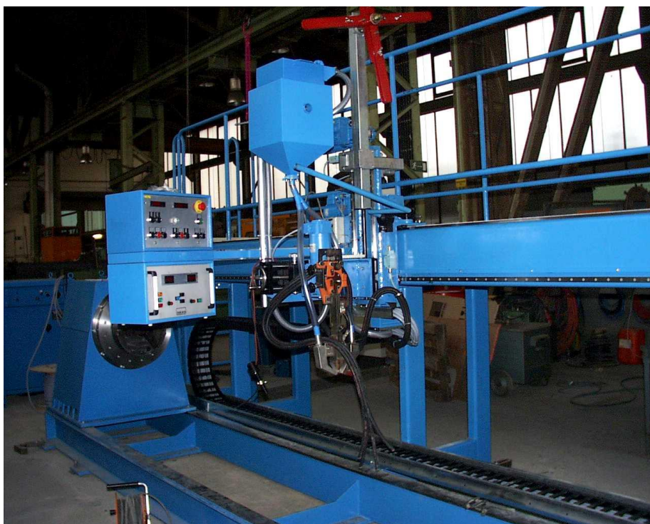
Slika 1.23. Čeoni pozicioner za zavarivanje osovina, EPP postupak, žica
