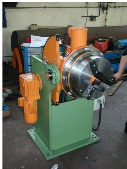
*Slika 1.8. Pozicioner UM-DT500 s tročeljusnom steznom glavom*
