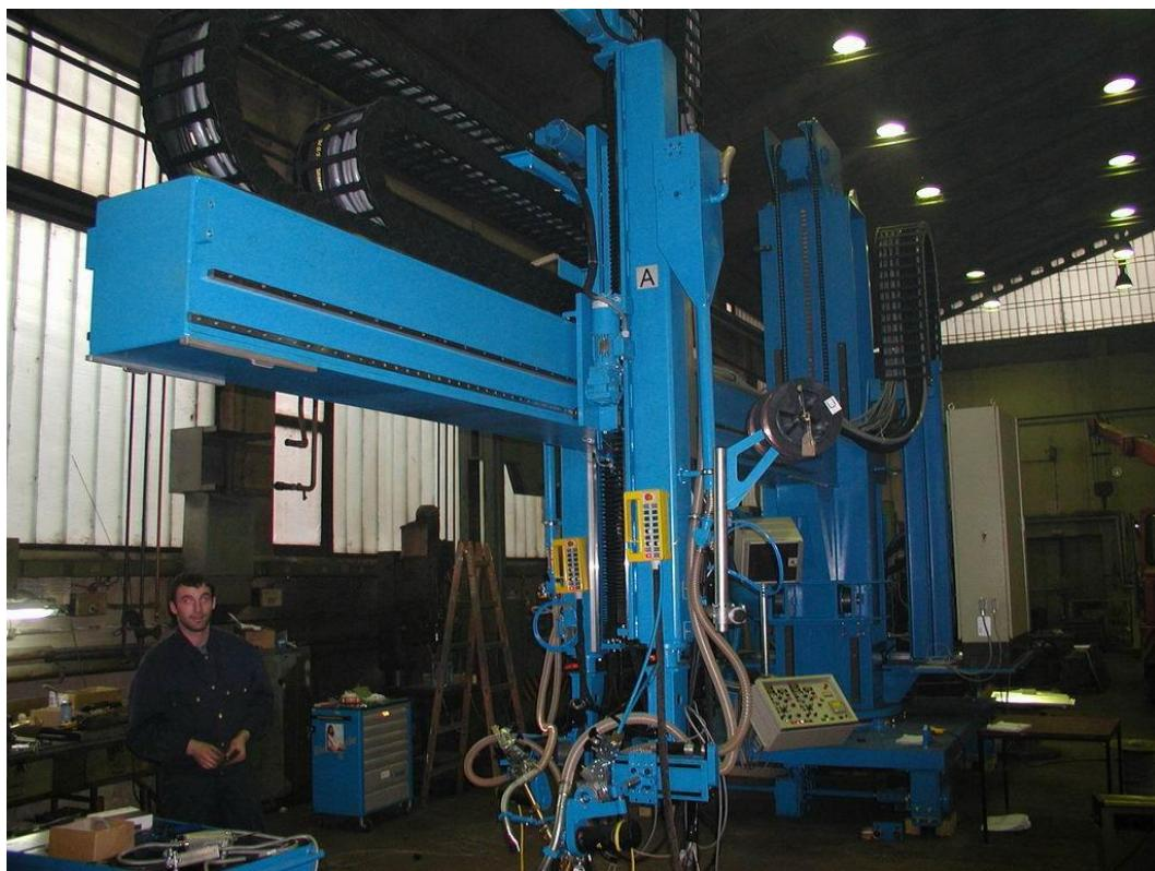
*Slika 1.16. „Jednoruki“ nosač automata, EPP oprema*
