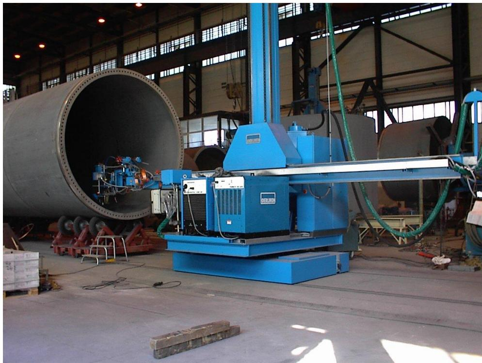
Slika 1.14. Nosač automata s EPP glavom
