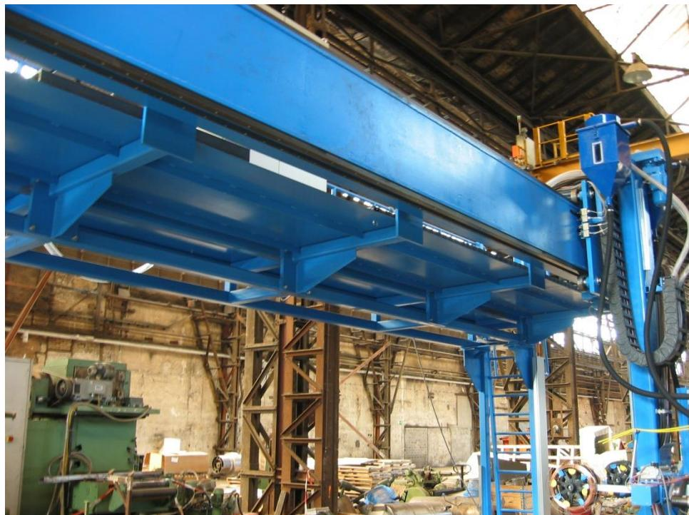
Slika 1.18. Portalni nosač automata 9 m, 2x EPP „tandem“
