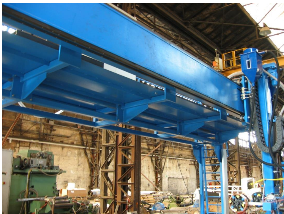
Slika 1.18. Portalni nosač automata 9 m, 2x EPP „tandem“
