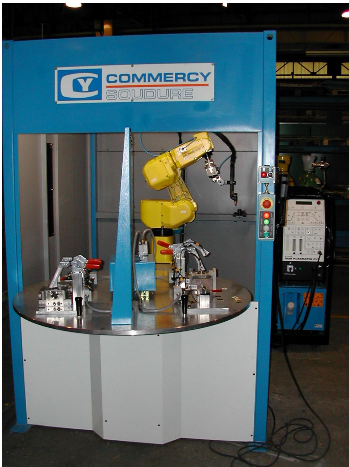
Slika 1.34. Robotska stanica s dva alata
